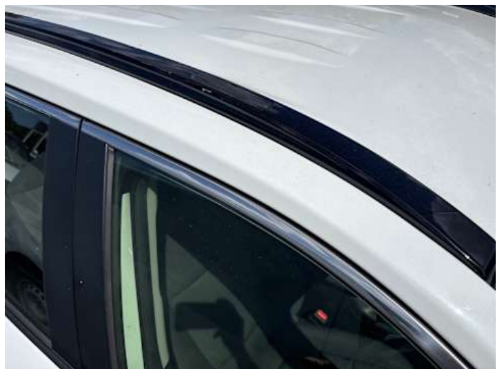
Dach (Riss/Bruch, Lackschaden)
