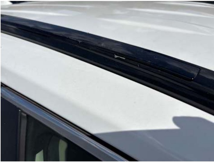
Dach (Riss/Bruch, Lackschaden)
