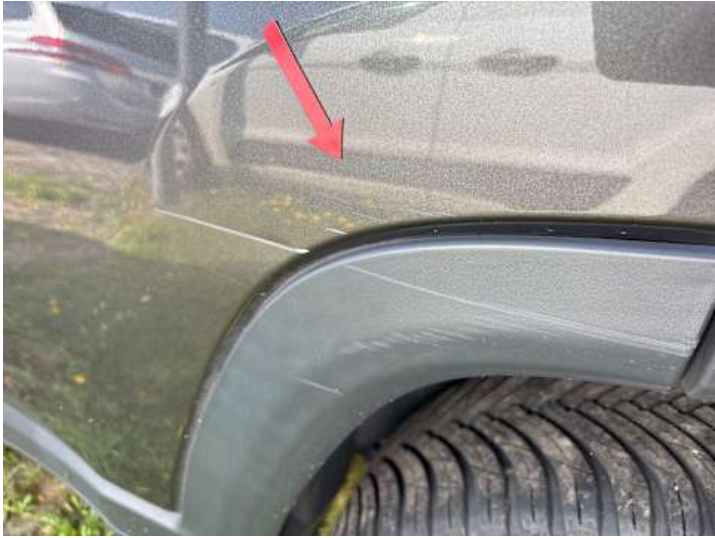
Türe hinten links (Kratzer)
