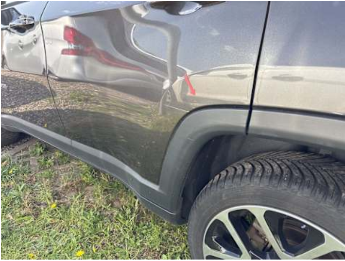
Türe hinten links (Kratzer)
