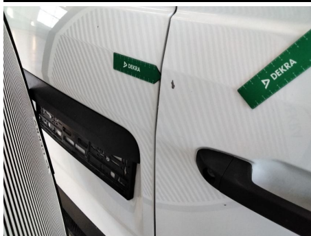
Heckklappe / Kofferraumtür / Hinten Rechts / Delle
