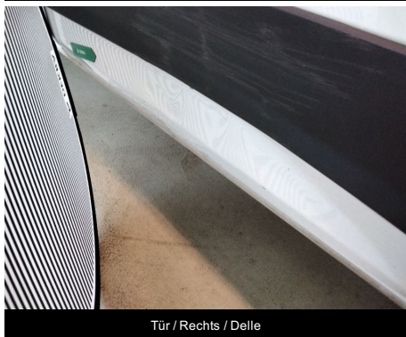
Tür / Rechts / Delle
