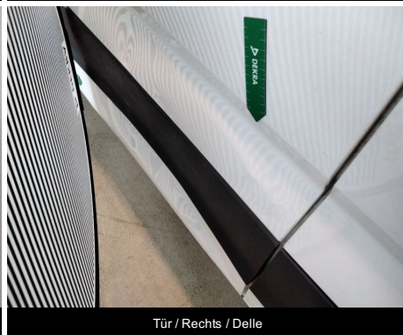
Tür / Rechts / Delle
