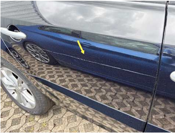
Türe hinten rechts (Lackschaden, Kratzer)
