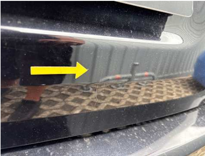
Heckklappe (Lackschaden, Kratzer)
