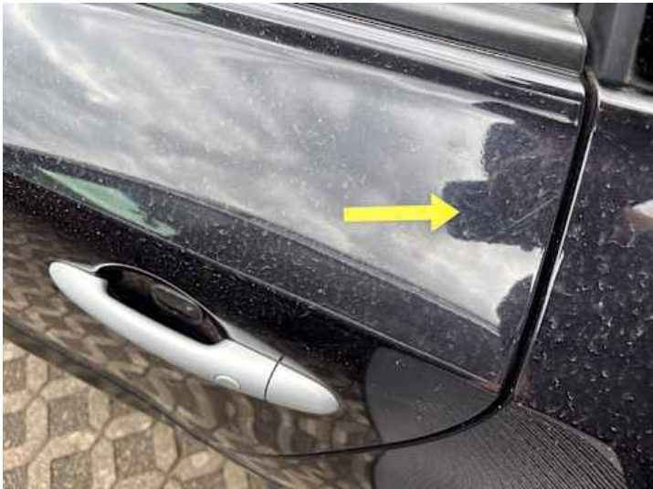
Türe hinten links (Lackschaden, Kratzer)
