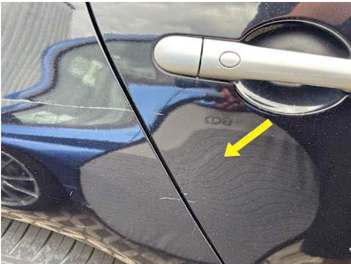
Türe hinten rechts (Lackschaden, Kratzer)
