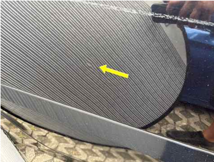
Beifahrtür (Delle, Lackschaden)
