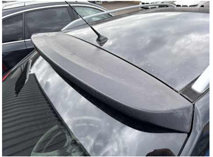
Heckklappe (Lackschaden, Ausgeblichen/Matt)
