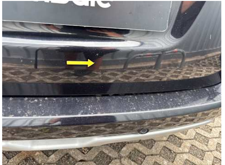
Heckklappe (Lackschaden, Kratzer)
