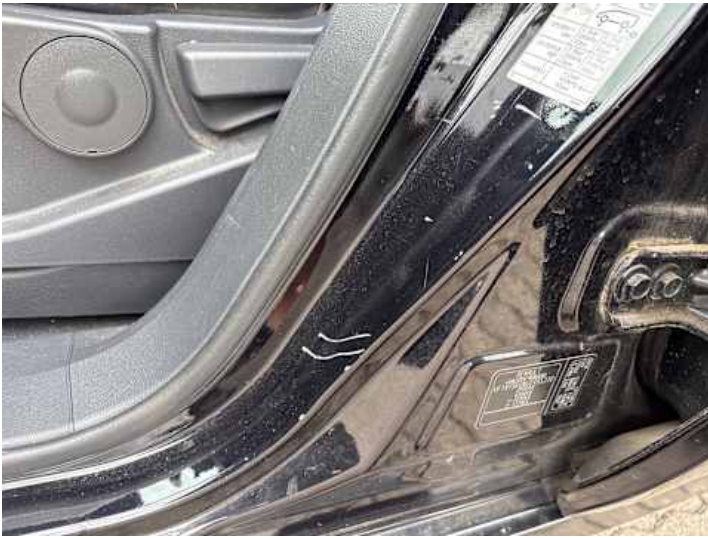
Schweller links (Lackschaden)
