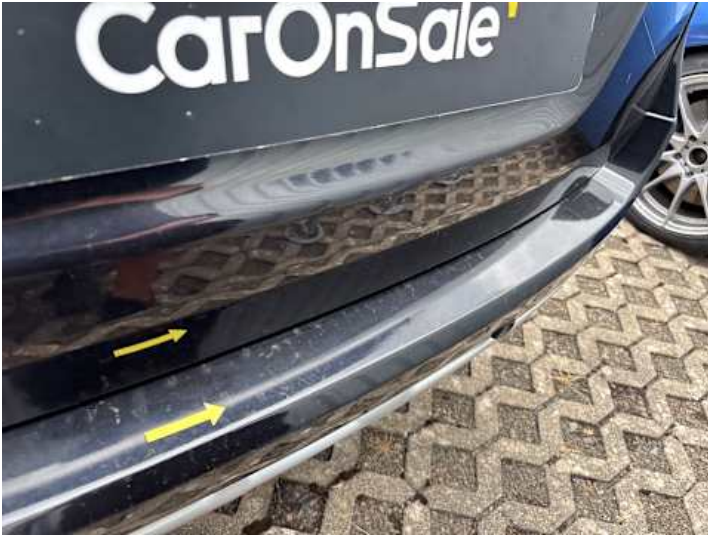
Stoßstange hinten (Lackschaden, Kratzer)
