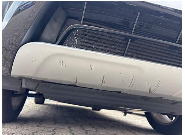
Stoßstange vorne (Lackschaden)
