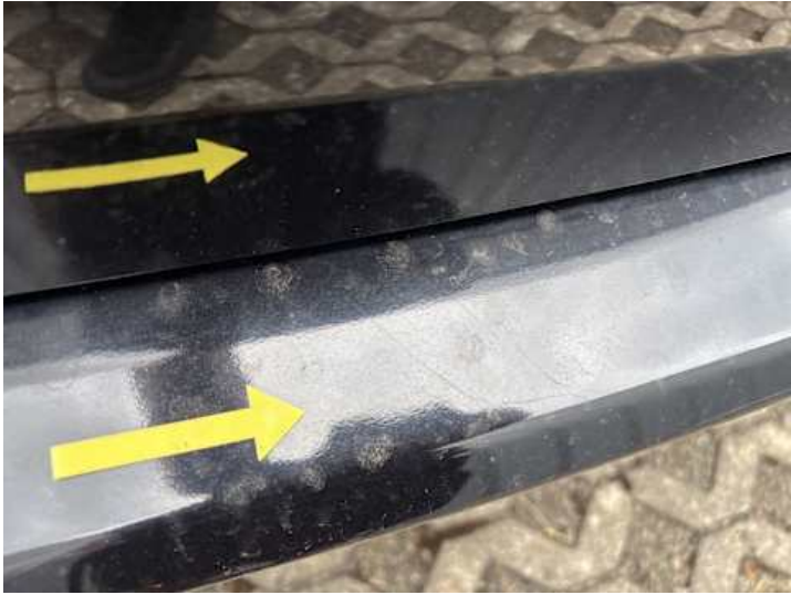
Stoßstange hinten (Lackschaden, Kratzer)
