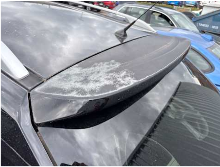
Heckklappe (Lackschaden, Ausgeblichen/Matt)
