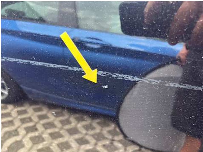
Türe hinten rechts (Lackschaden, Kratzer)
