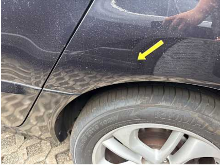
Seitenteil hinten links (Verformung, Delle)
