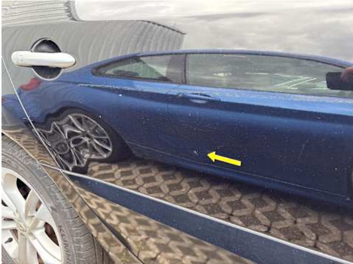
Beifahrtür (Delle, Lackschaden)
