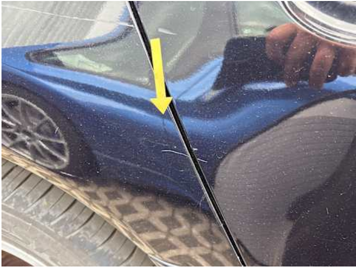
Seitenteil hinten rechts (Lackschaden, Kratzer)
