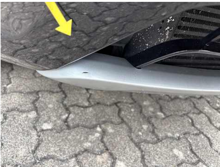
Stoßstange vorne (Lackschaden)
