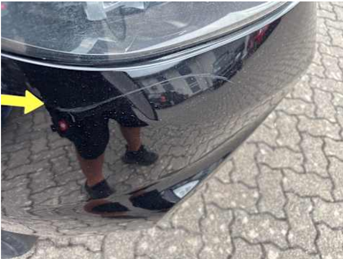
Stoßstange vorne (Lackschaden)
