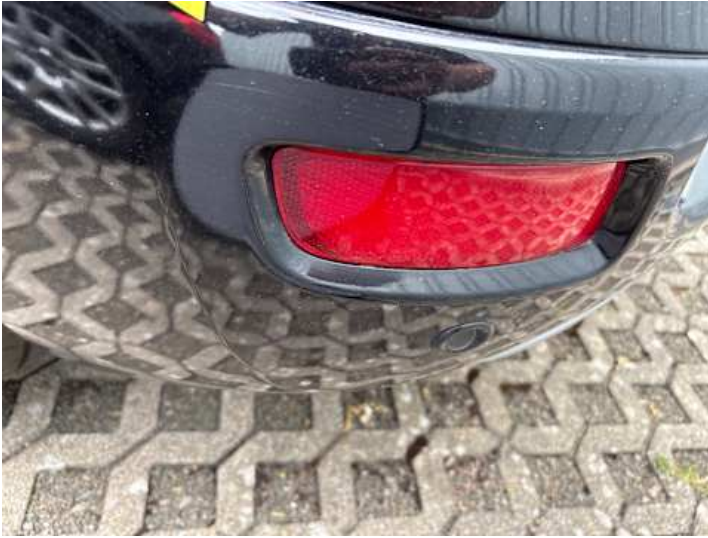
Stoßstange hinten (Lackschaden, Kratzer)
