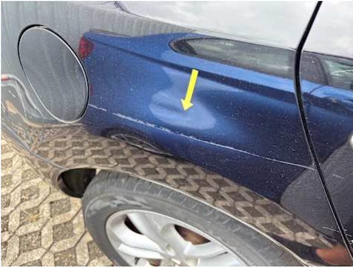
Seitenteil hinten rechts (Lackschaden, Kratzer)
