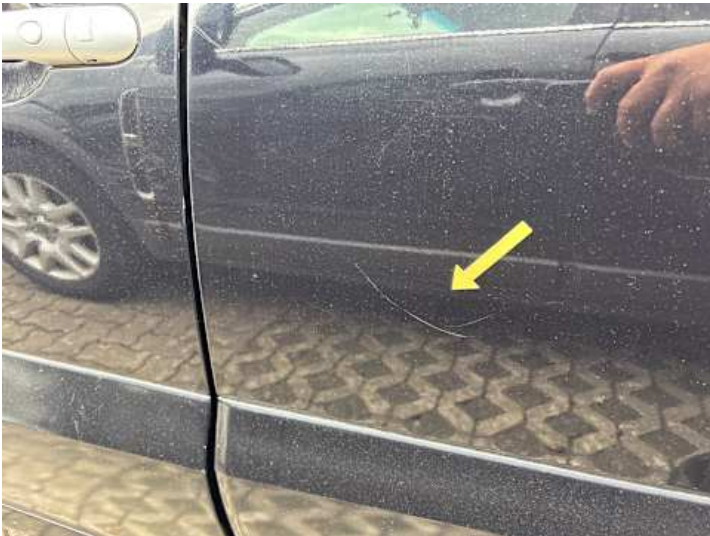
Türe hinten links (Lackschaden, Kratzer)
