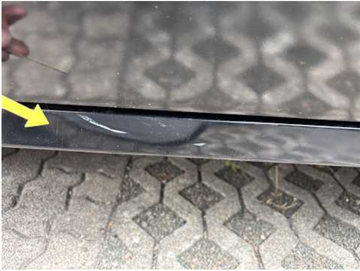
Schweller links (Lackschaden)
