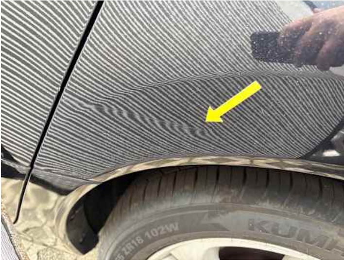
Seitenteil hinten links (Verformung, Delle)
