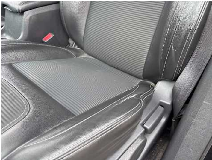
Innenraum (Verschleiß, Riss/Bruch)
