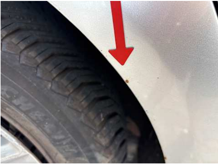
Seitenteil hinten rechts (Kratzer, Rost)
