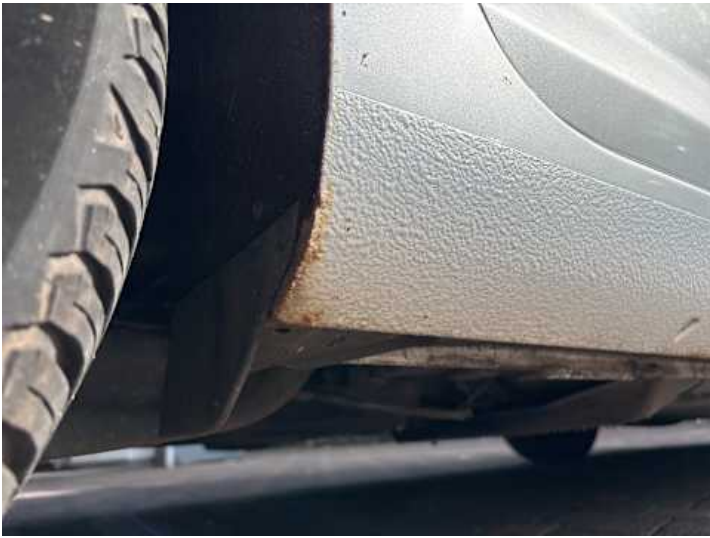
Schweller rechts (Kratzer, Rost)
