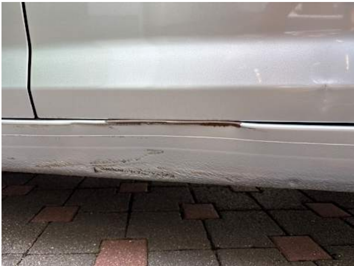
Schweller links (Verformung, Rost)
