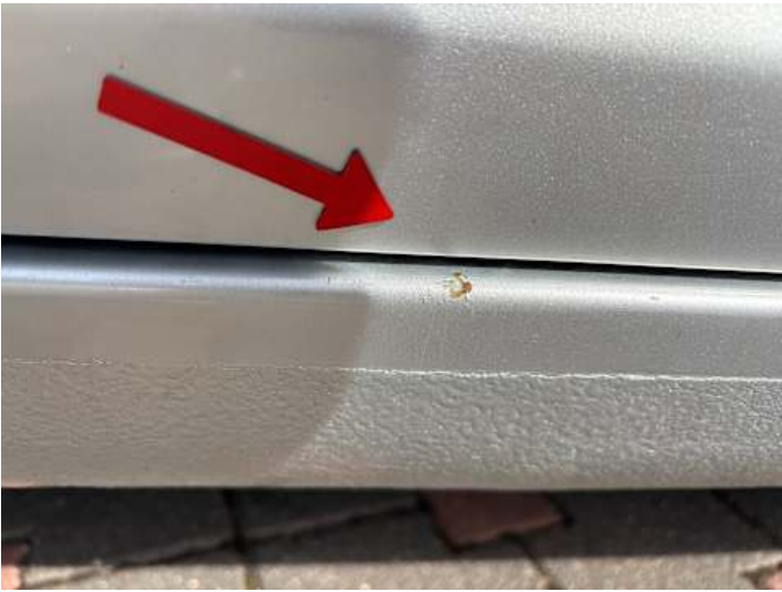
Schweller rechts (Kratzer, Rost)
