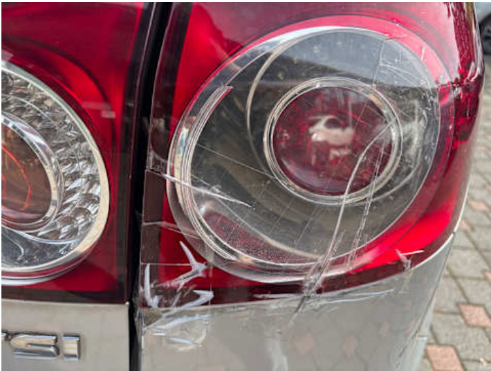
Rücklicht (rechts) (Riss/Bruch)
