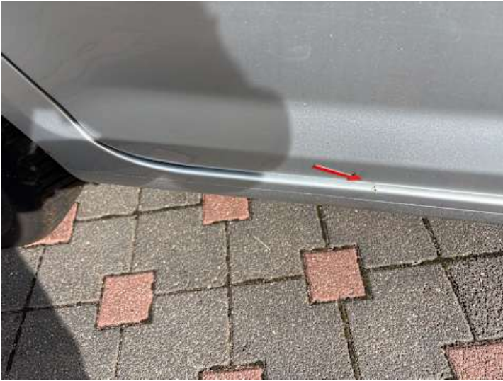
Schweller rechts (Kratzer, Rost)
