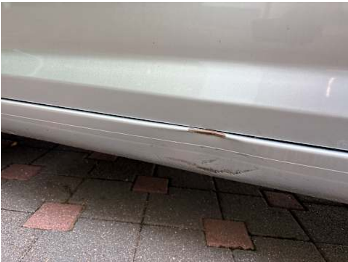
Schweller links (Verformung, Rost)
