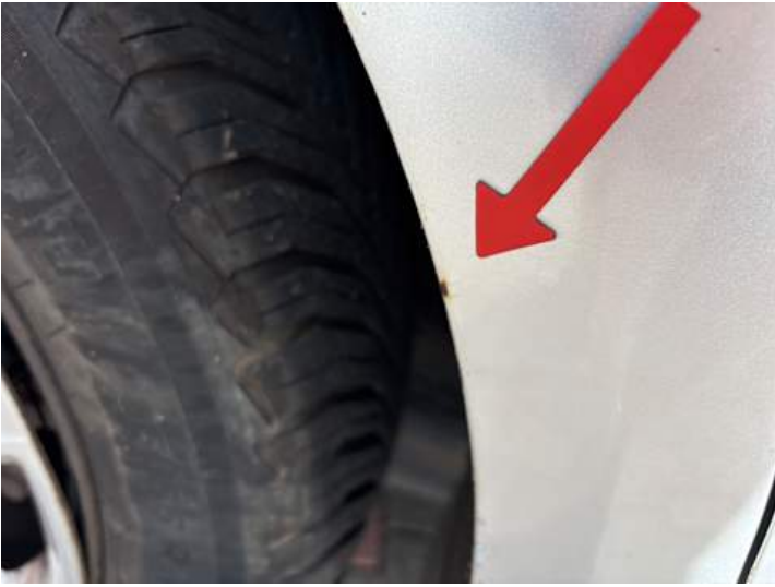
Seitenteil hinten rechts (Kratzer, Rost)
