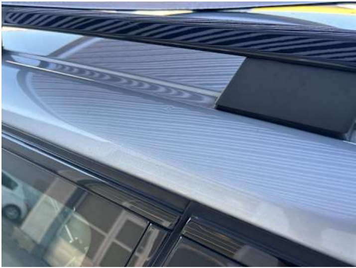
Dach (Kratzer, Delle)
