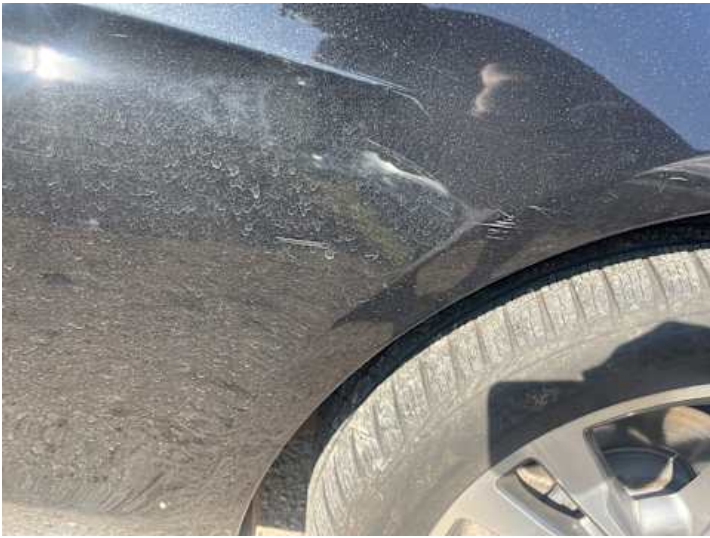
Kotflügel vorne rechts (Kratzer, Lackschaden)
