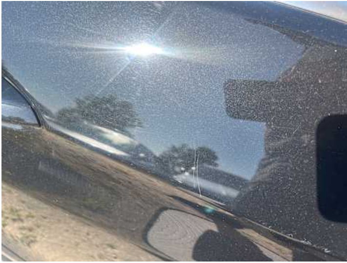
Türe hinten rechts (Kratzer, Lackschaden)
