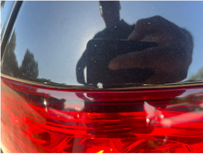
Seitenteil hinten rechts (Steinschlag, Lackschaden)
