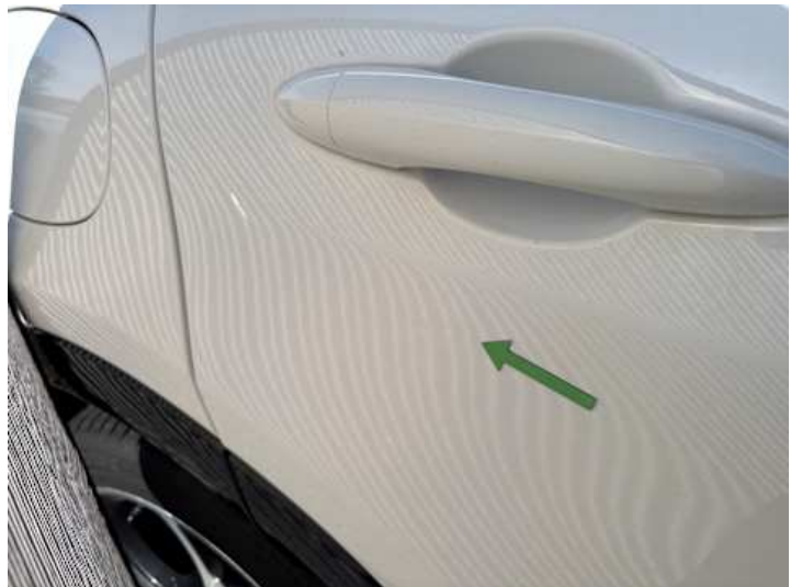
Türe hinten rechts (Delle)
