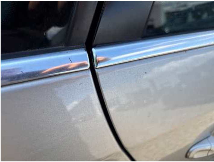
Türe hinten rechts (Lackschaden, Delle)
