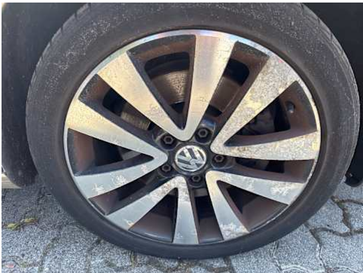
Rad (vehicle.damage-label.porous, Ungleichmäßig abgefahren, Rost)
