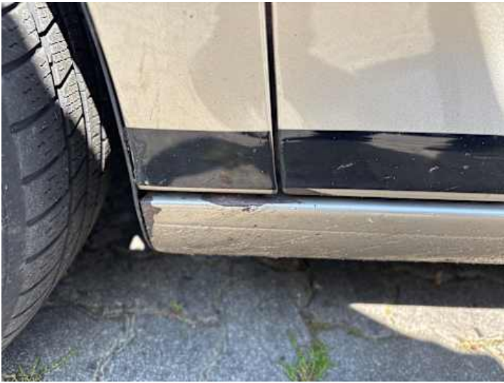
Schweller links (Rost, Lackschaden)
