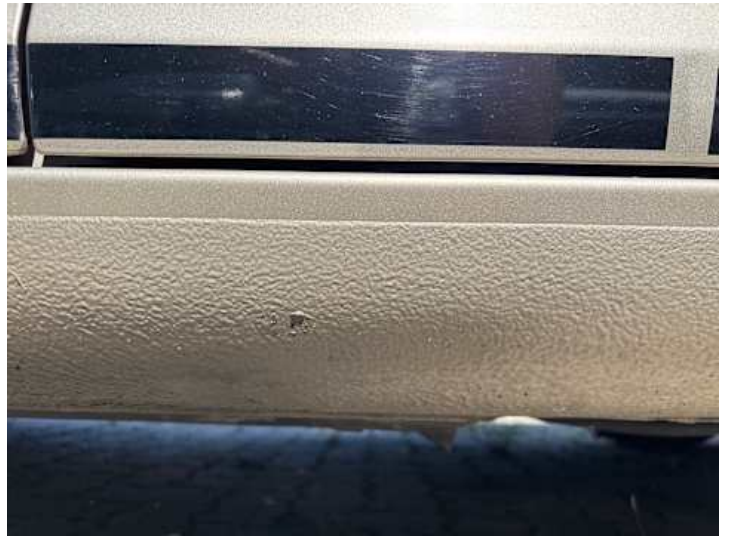
Schweller links (Rost, Lackschaden)
