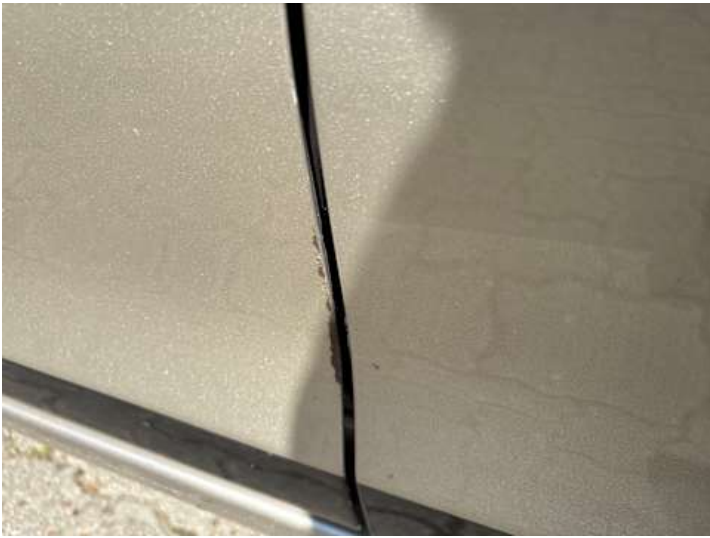
Fahrtür (Lackschaden, Kratzer)
