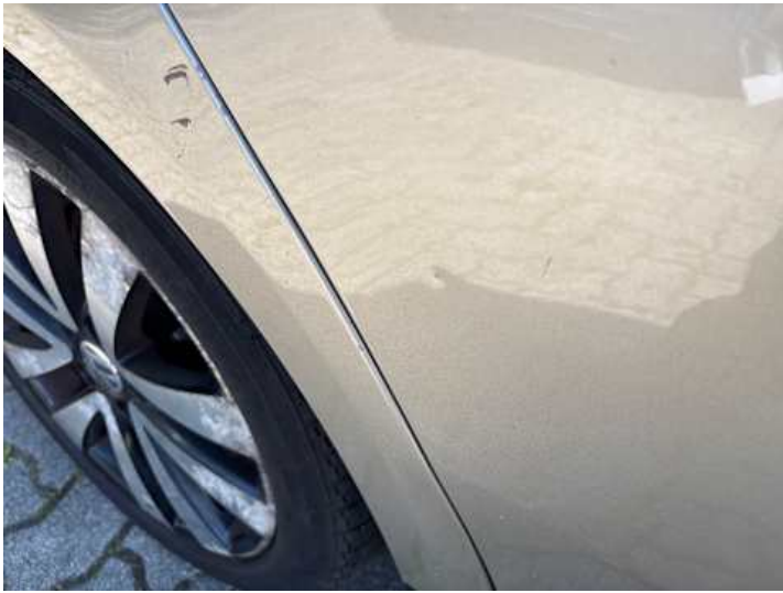
Türe hinten rechts (Lackschaden, Delle)
