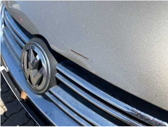
Motorhaube (Anderer Schaden, Verformung, Lackschaden, Rost): Öffnet nicht
