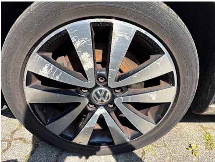
Rad (vehicle.damage-label.porous, Ungleichmäßig abgefahren, Rost)
