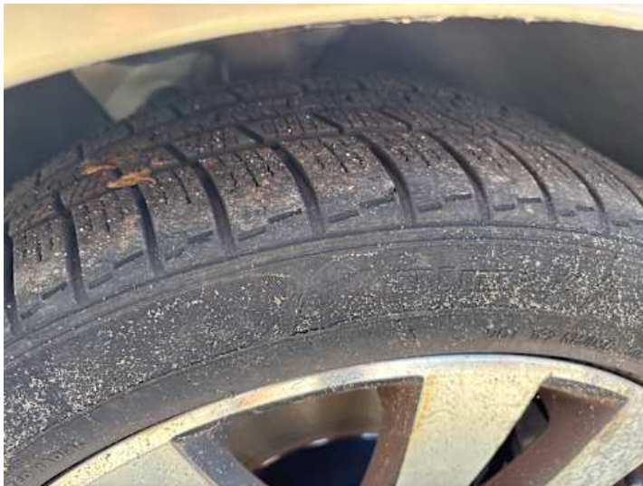
Rad (vehicle.damage-label.porous, Ungleichmäßig abgefahren, Rost)
