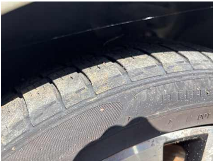
Rad (vehicle.damage-label.porous, Ungleichmäßig abgefahren, Rost)
