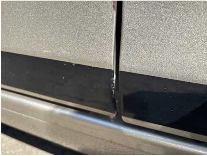
Fahrtür (Lackschaden, Kratzer)
