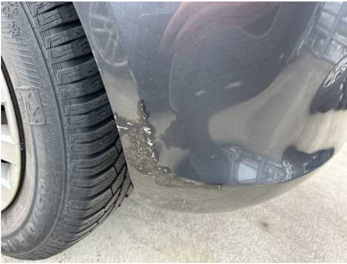
Seitenteil hinten rechts (Kratzer, Verformung, Rost)
