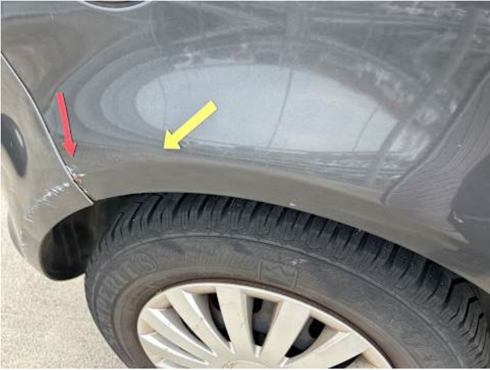
Seitenteil hinten rechts (Kratzer, Verformung, Rost)
