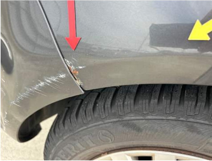
Seitenteil hinten rechts (Kratzer, Verformung, Rost)
