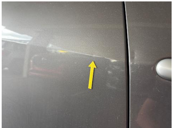
Türe hinten rechts (Delle)
