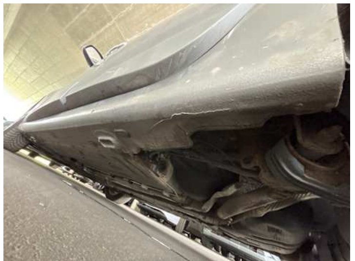
Schweller links (Rost)
