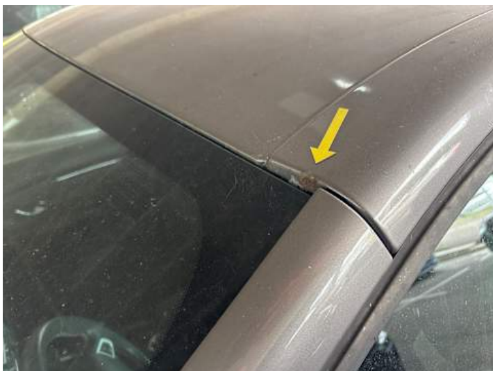
Dach (Steinschlag, Rost)
