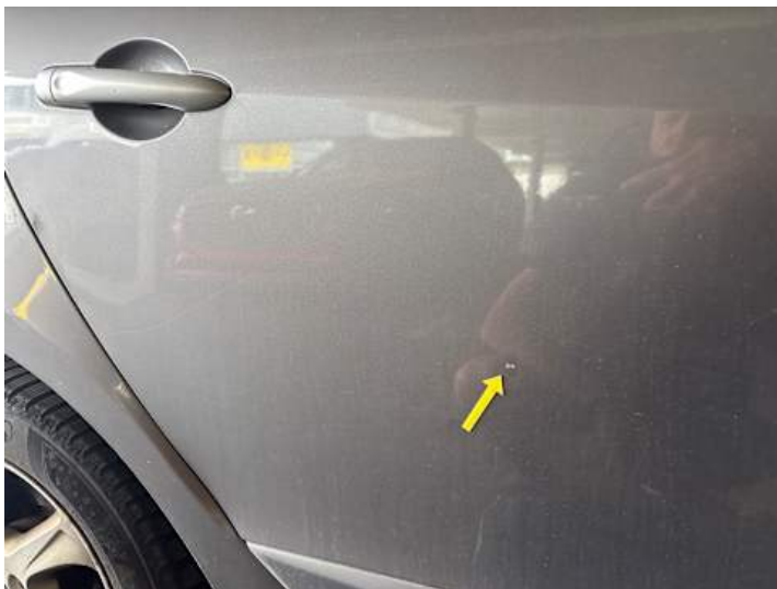
Türe hinten rechts (Kratzer, Rost)
