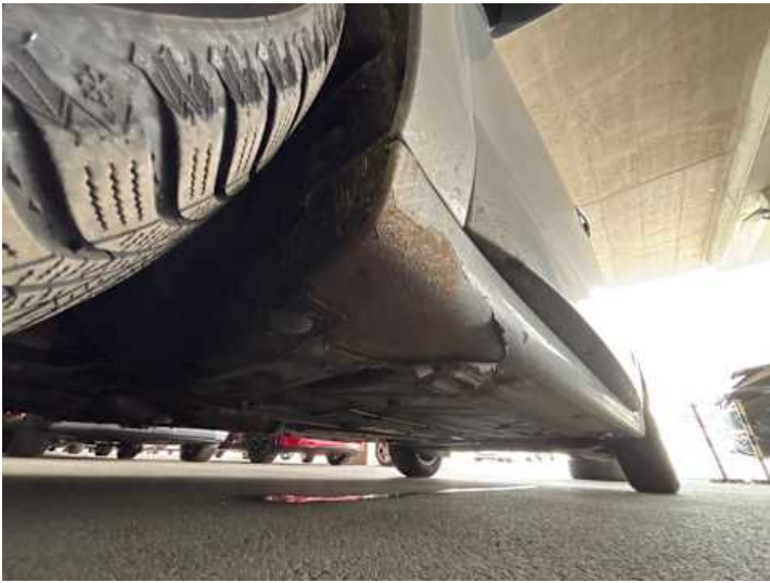
Schweller links (Rost)
