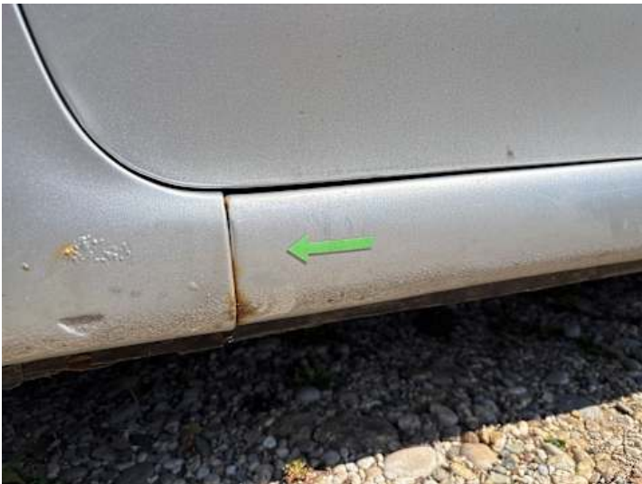
Schweller links (Rost)
