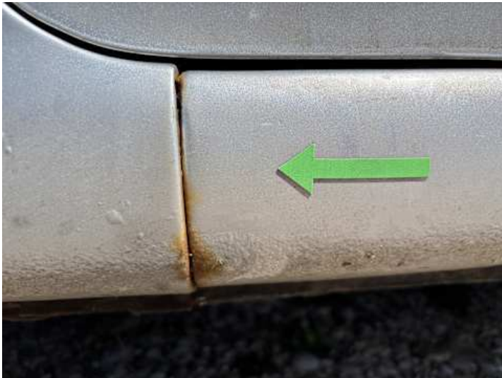
Schweller links (Rost)
