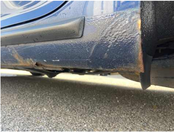
Schweller links (Rost, Lackschaden, Unsachgemäß instand gesetzt)
