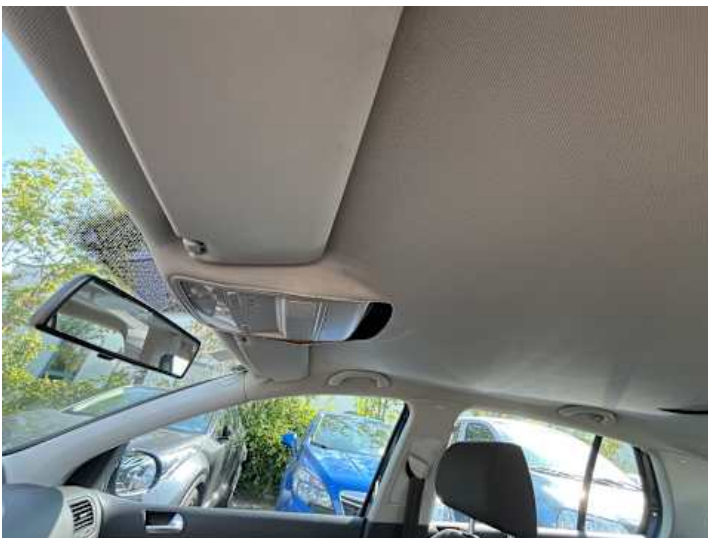
Innenraum (Anderer Schaden): Dachhimmel hängt;
