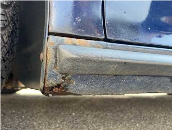
Schweller links (Rost, Lackschaden, Unsachgemäß instand gesetzt)
