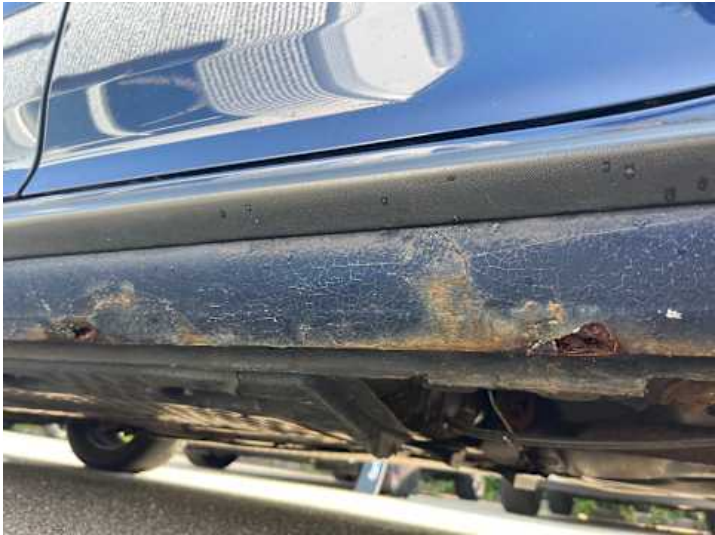
Schweller links (Rost, Lackschaden, Unsachgemäß instand gesetzt)
