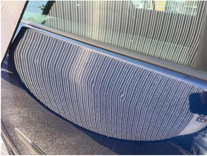
Türe hinten rechts (Delle)
