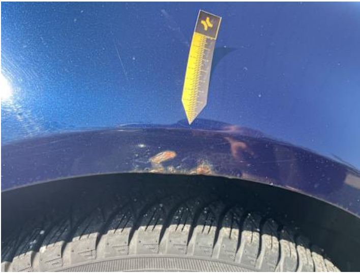
Kotflügel vorne rechts (Lackschaden, Rost)
