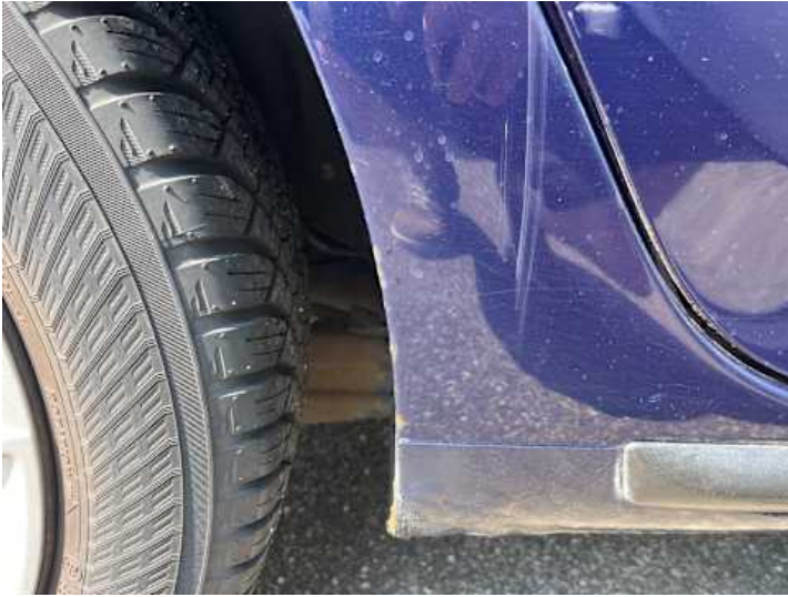
Seitenteil hinten rechts (Lackschaden, Rost)
