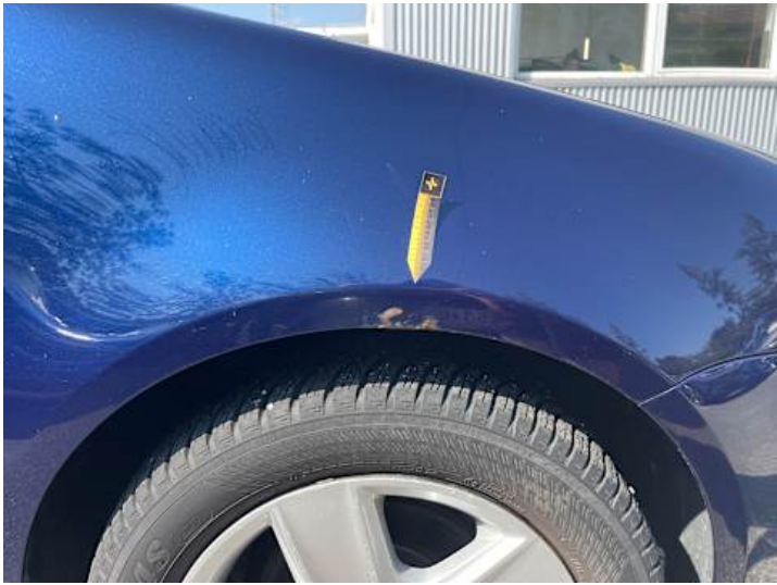
Kotflügel vorne rechts (Lackschaden, Rost)
