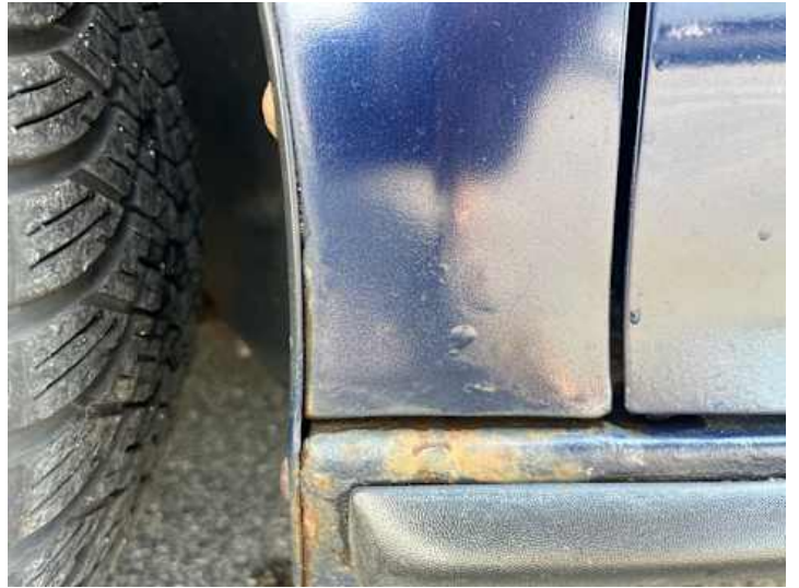
Kotflügel vorne links (Rost, Lackschaden, Unsachgemäß instand gesetzt)
