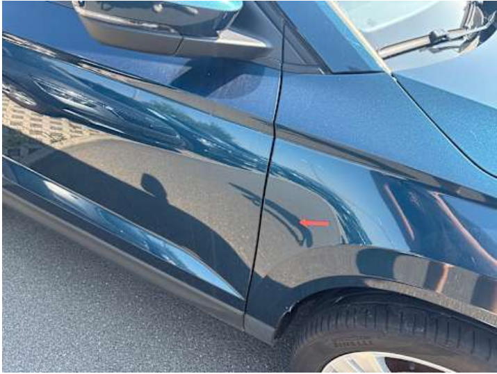
Kotflügel vorne rechts (Delle)
