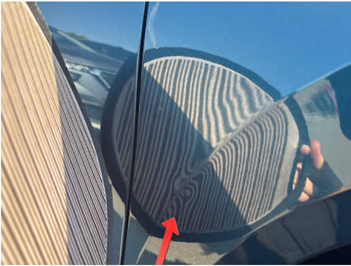
Kotflügel vorne rechts (Delle)
