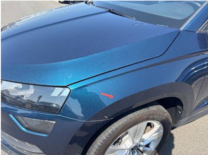
Kotflügel vorne links (Kratzer)
