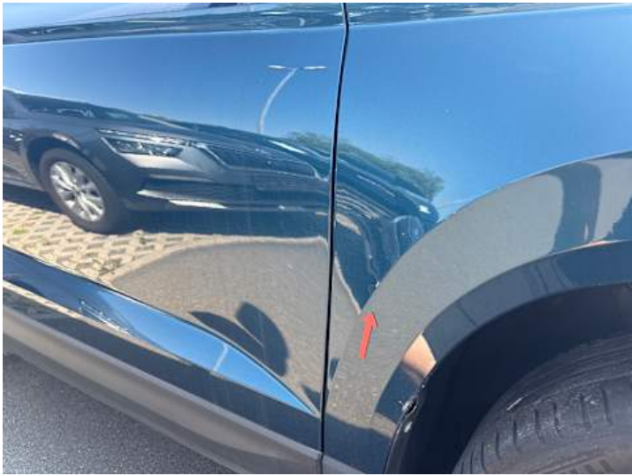
Kotflügel vorne rechts (Delle)
