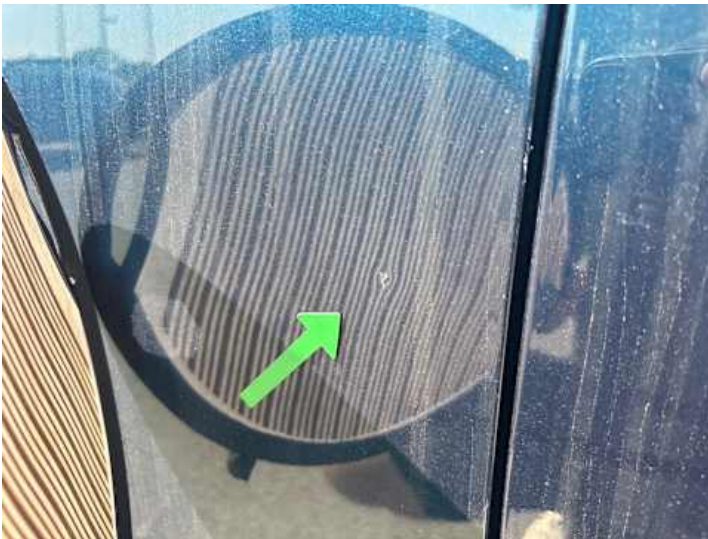
Fahrtür (Delle, Lackschaden)
