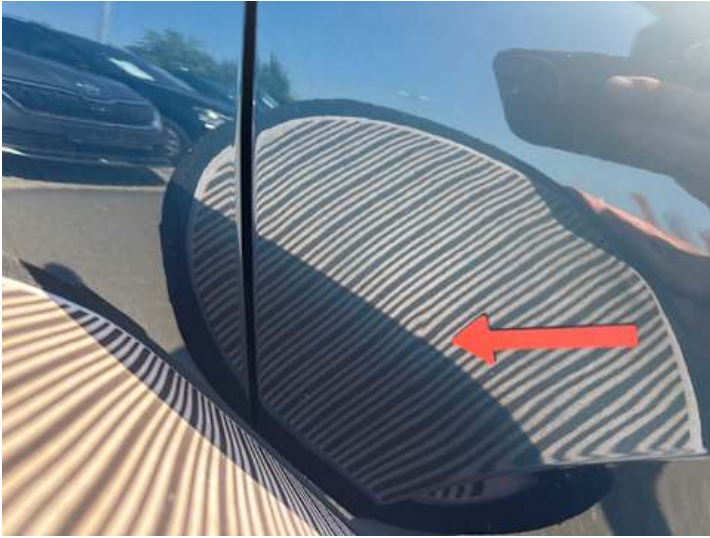
Kotflügel vorne rechts (Delle)
