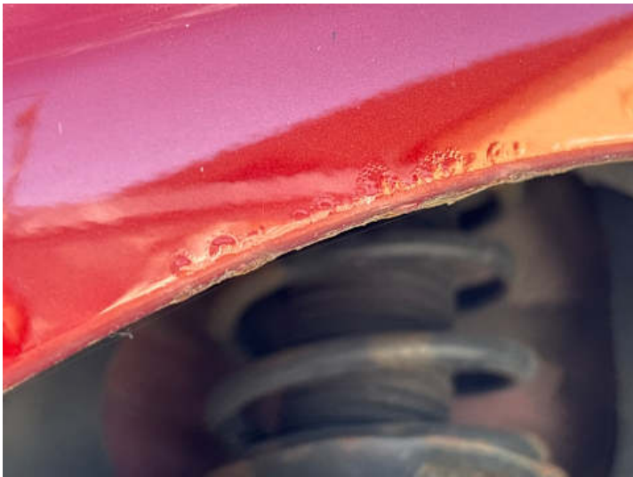
Kotflügel vorne links (Lackschaden, Rost)
