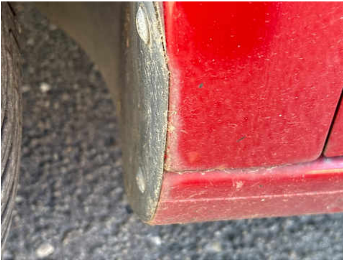
Kotflügel vorne links (Lackschaden, Rost)
