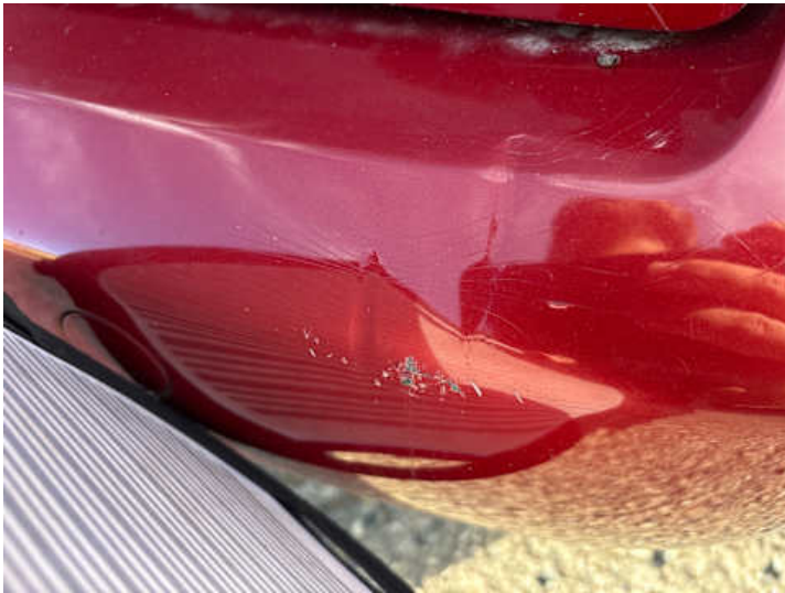
Stoßstange hinten (Kratzer, Lackschaden, Verformung)
