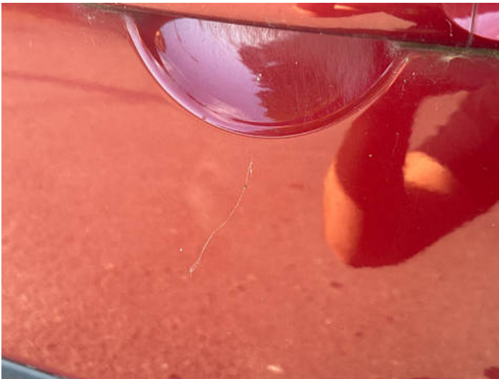
Fahrertür (Kratzer, Lackschaden)
