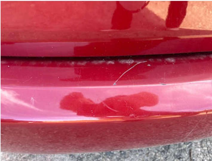
Stoßstange hinten (Kratzer, Lackschaden, Verformung)
