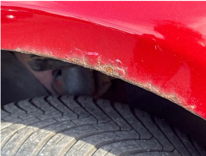
Kotflügel vorne rechts (Rost, Lackschaden)
