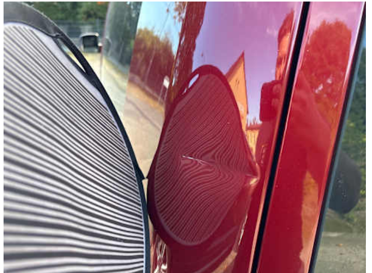
Seitenteil hinten links (Verformung)
