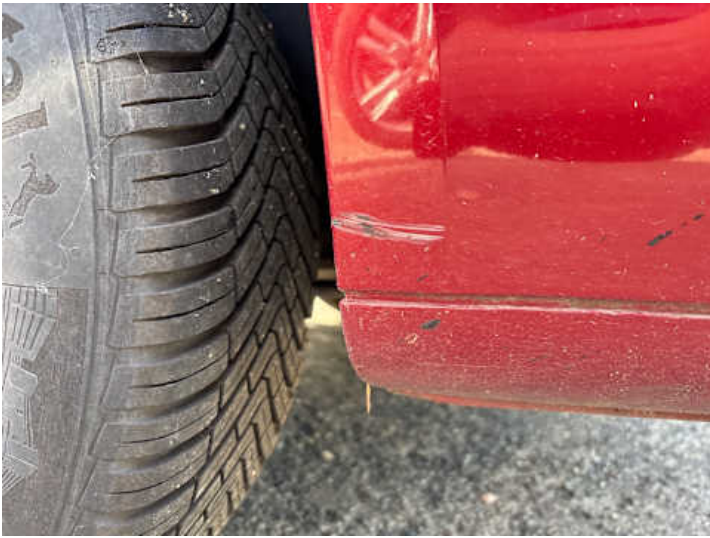
Stoßstange hinten (Kratzer, Lackschaden, Verformung)
