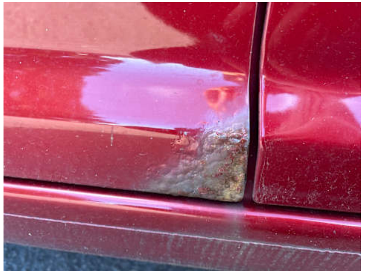
Fahrertür (Lackschaden, Rost)
