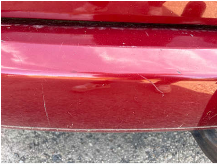
Stoßstange hinten (Kratzer, Lackschaden, Verformung)
