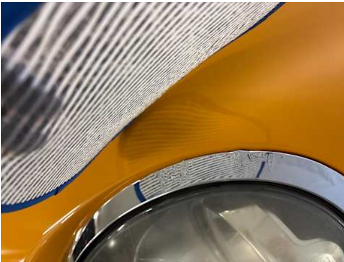
Scheinwerfer (links) (Riss/Bruch)
