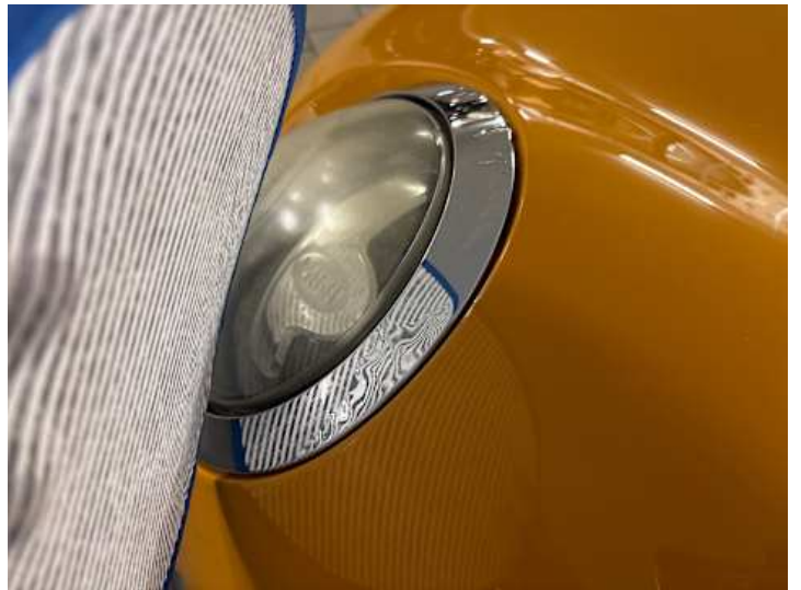
Scheinwerfer (links) (Riss/Bruch)
