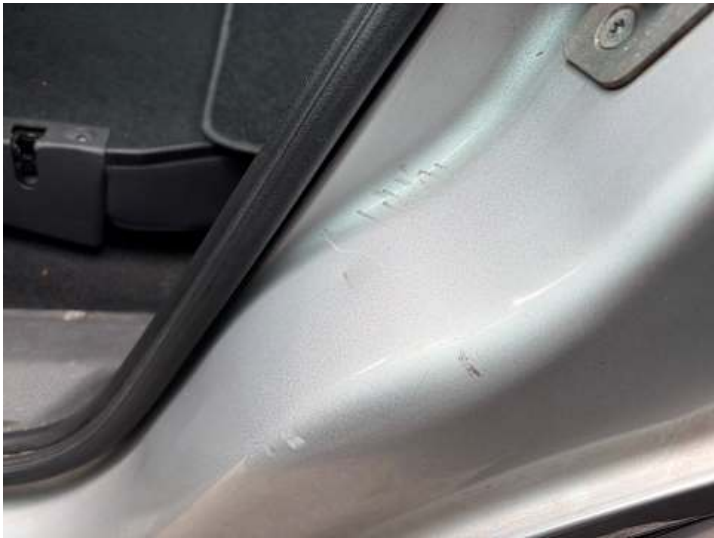
Schweller links (Kratzer)
