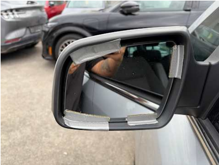
Fahrtür (Unsachgemäß instand gesetzt)
