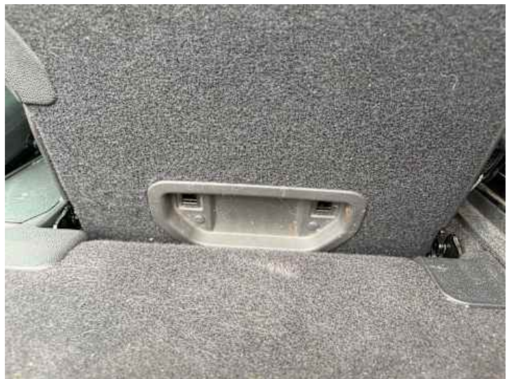
Innenraum (Anderer Schaden): Griff nicht vorhanden
