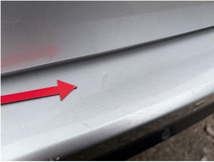
Stoßstange hinten (Verformung)
