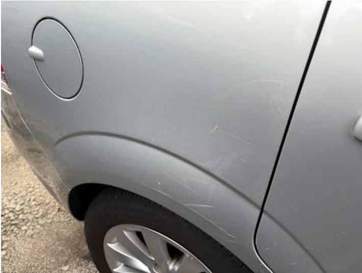
Seitenteil hinten rechts (Kratzer)
