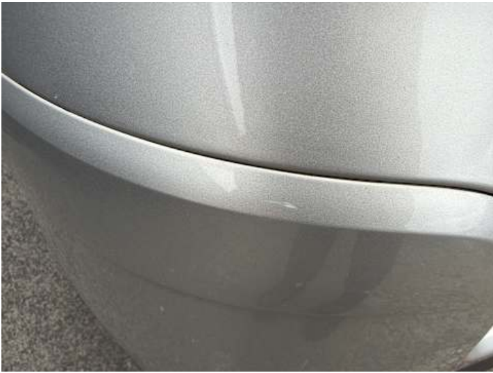
Stoßstange hinten (Lackschaden)
