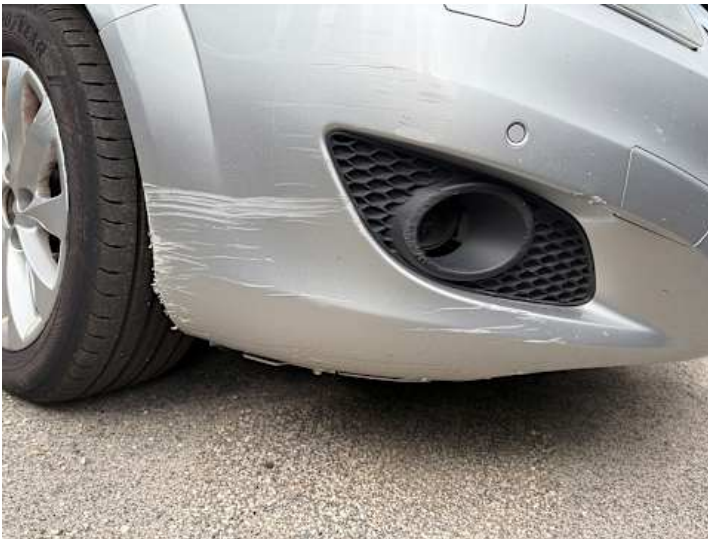
Stoßstange vorne (Lackschaden)
