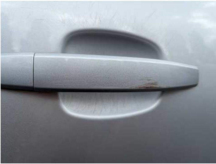
Türe hinten rechts (Lackschaden)
