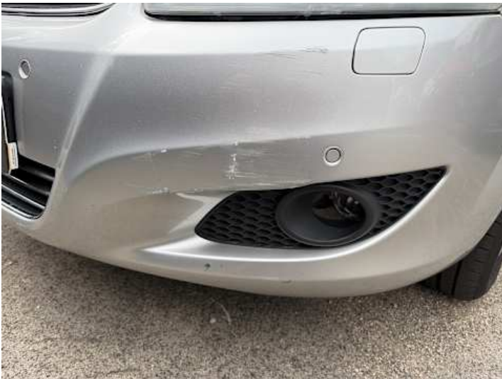
Stoßstange vorne (Lackschaden)
