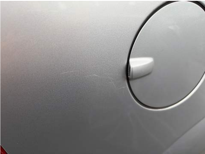
Seitenteil hinten rechts (Kratzer)
