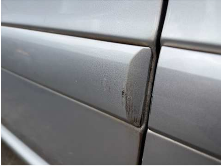
Türe hinten rechts (Lackschaden)
