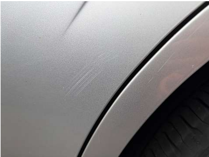
Türe hinten links (Kratzer)
