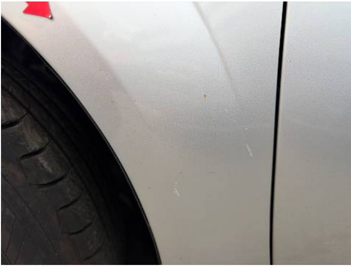
Kotflügel vorne links (Kratzer)
