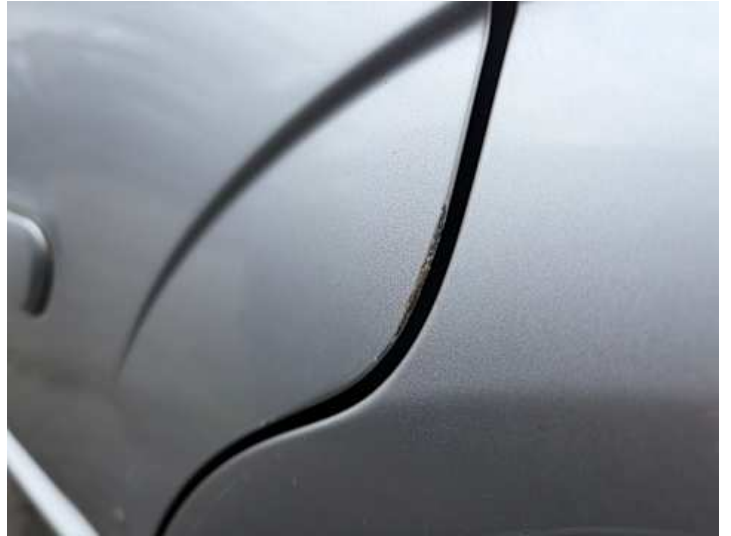
Türe hinten links (Lackschaden)
