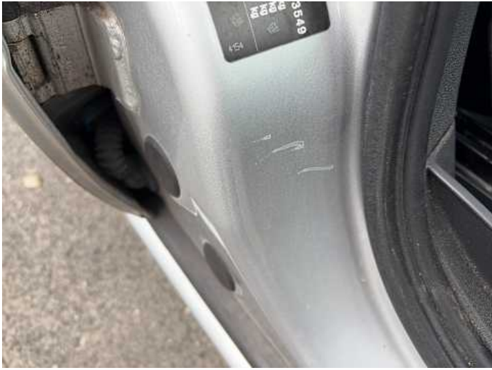
Schweller rechts (Kratzer)
