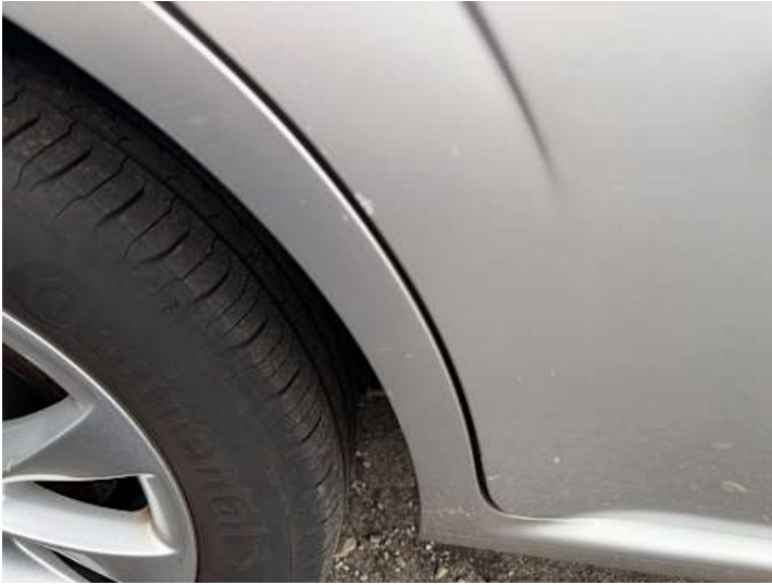
Türe hinten rechts (Lackschaden)
