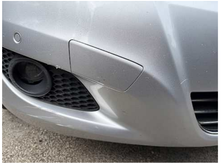
Stoßstange vorne (Lackschaden)
