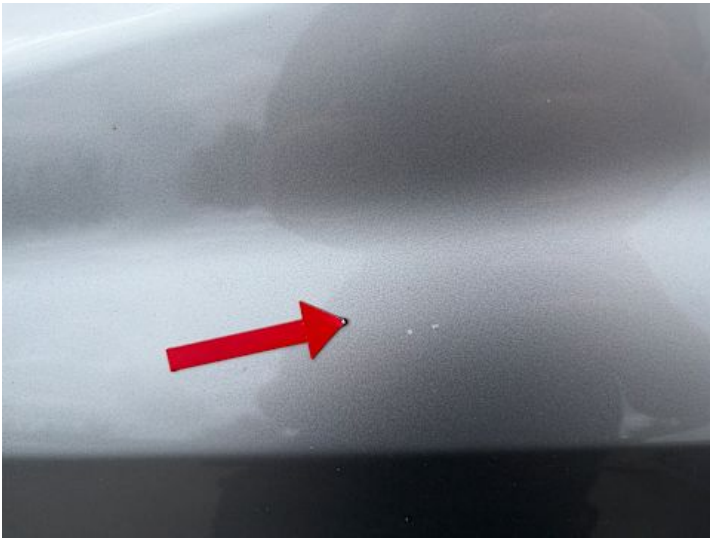
Kotflügel vorne links (Lackschaden)
