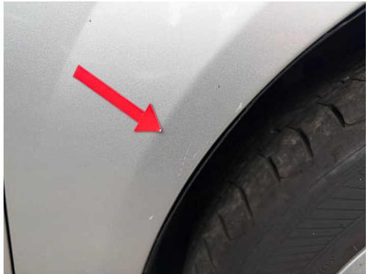
Kotflügel vorne rechts (Lackschaden)
