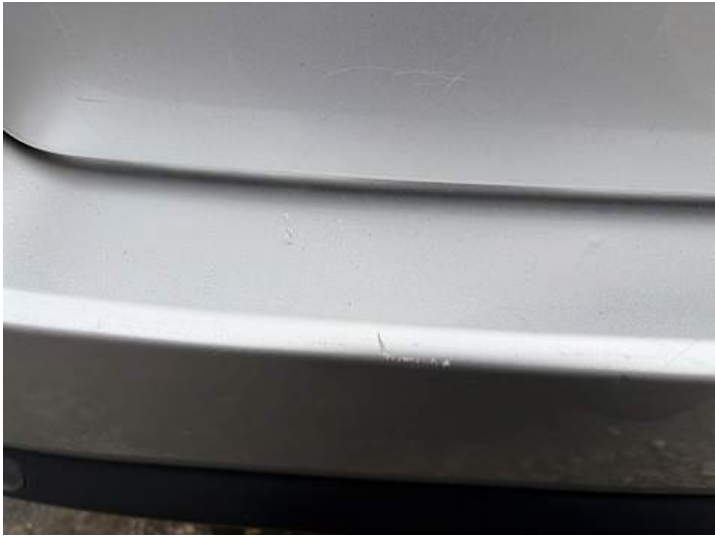
Stoßstange hinten (Lackschaden)
