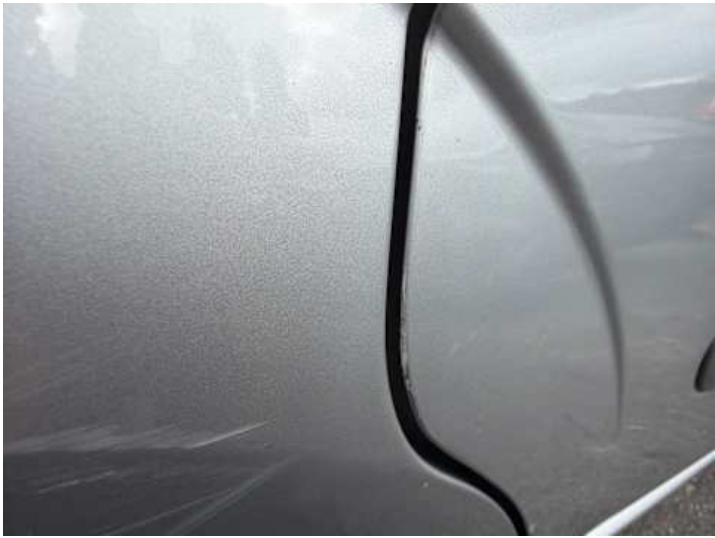
Türe hinten rechts (Lackschaden)
