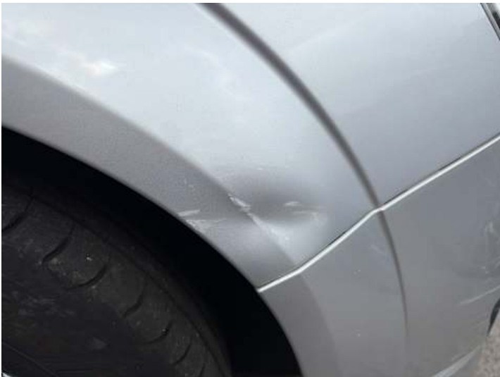
Kotflügel vorne rechts (Lackschaden, Verformung)
