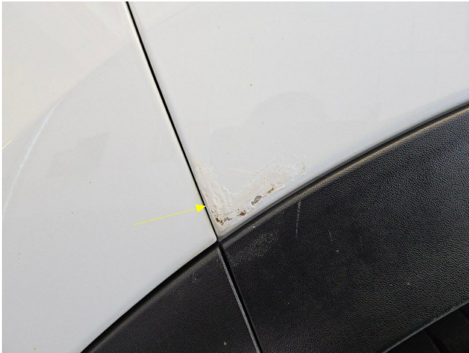
Bild 15 : Diverse Gebrauchsspuren, Kratzer, Dellen und Umweltbeaufschlagung rundum Seitenteil hinten rechts
