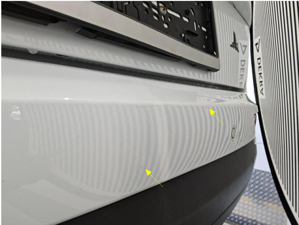
Bild 13 : Diverse Kratzer, Dellen und Umweltbeaufschlagung rundum Stoßfänger hinten
