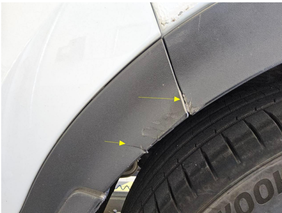
Bild 16 : Diverse Gebrauchsspuren, Kratzer, Dellen und Umweltbeaufschlagung rundum Radzierblende verschrammt
