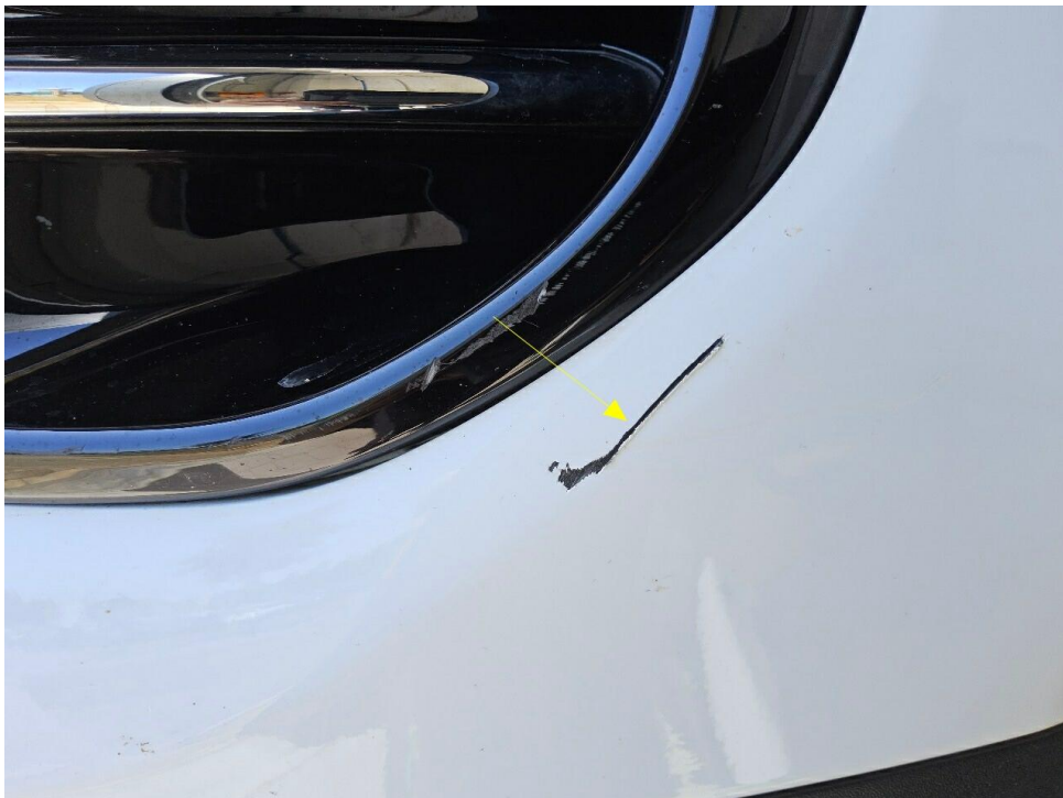
Bild 10 : Stoßfänger vorne zerkratzt
