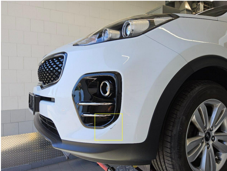
Bild 9 : Stoßfänger vorne zerkratzt
