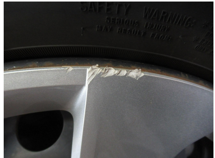
Bild 2: Außen, Felge vorne rechts - Radzierdeckel, verschrammt, erneuern
