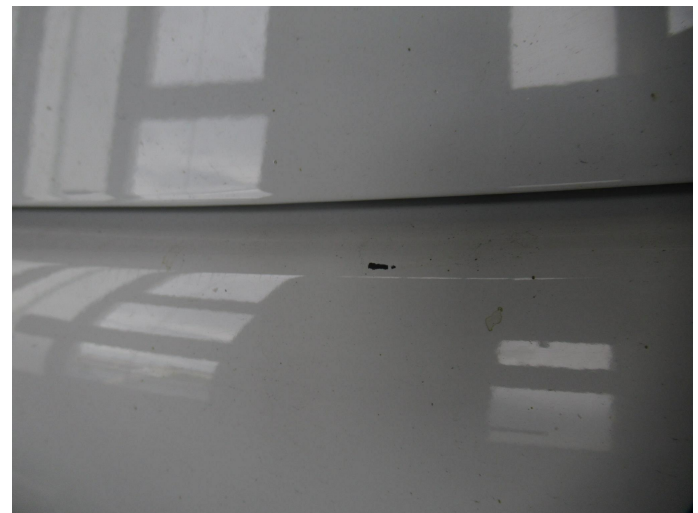
Bild 4: Außen, Stoßfänger hinten - Lackierung, verschrammt, smart repair
