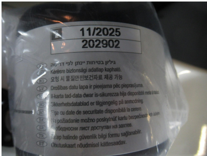
Bild 1: Technik, Reifenfüllmittel, MHD abgelaufen, erneuern
