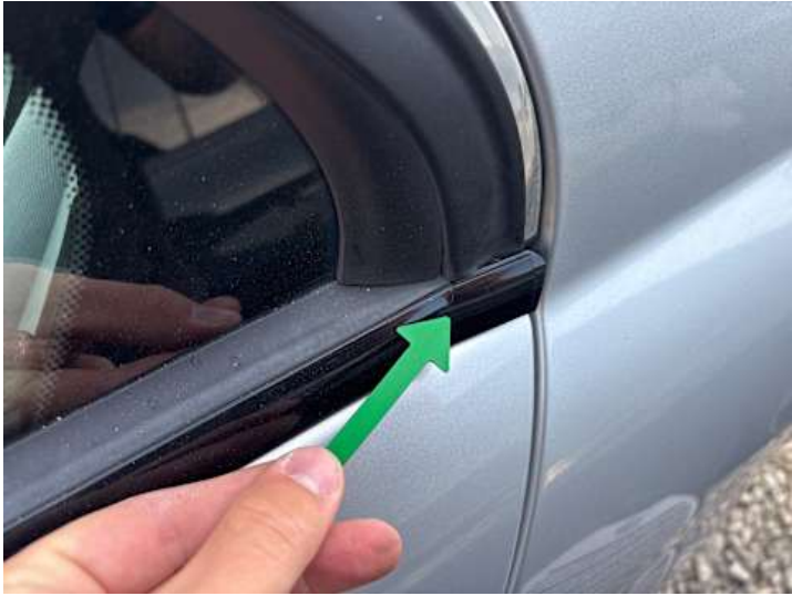
Türe hinten links (Verformung, Riss/Bruch)
