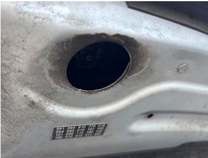
Motorhaube (Lackschaden, Rost)
