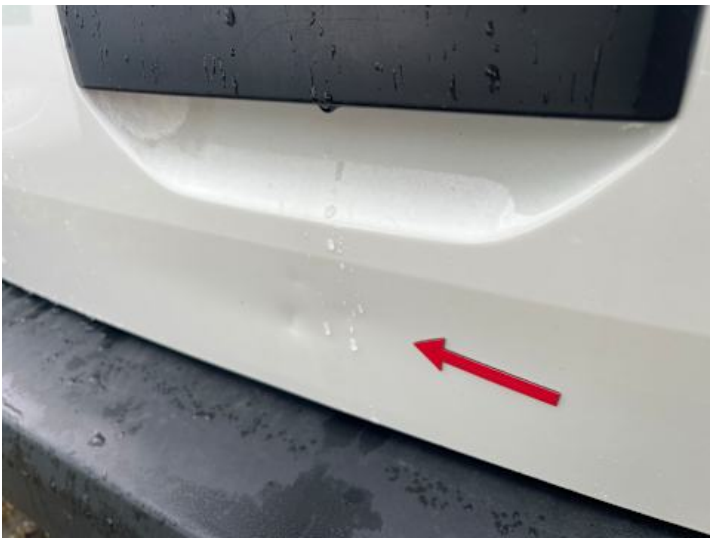
Heckklappe (Lackschaden, Verformung)
