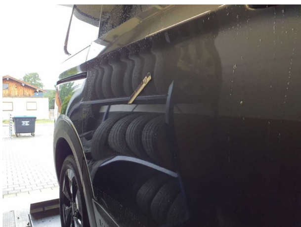
Beschädigung #1: Schiebetür rechts: Schiebetür - Delle(n) - sanft instandsetzen
