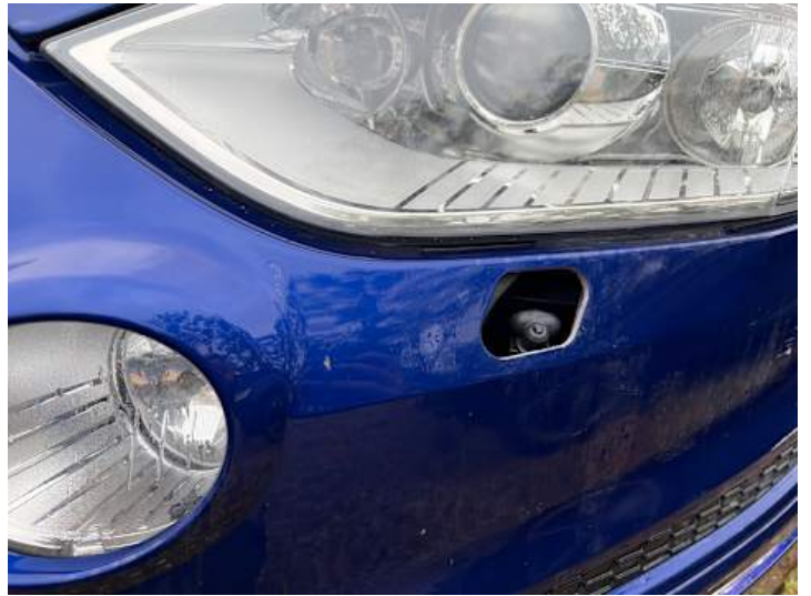
Stoßstange vorne (Anderer Schaden): Abdeckung fehlt
