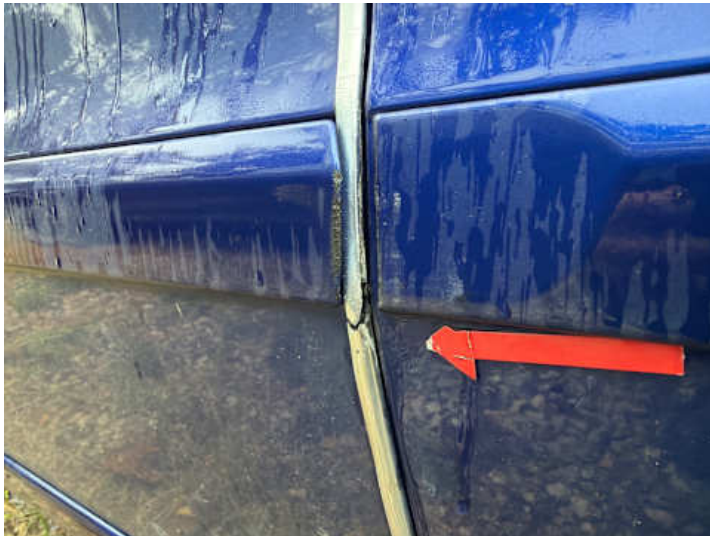
Fahrtür (Riss/Bruch, Lackschaden)
