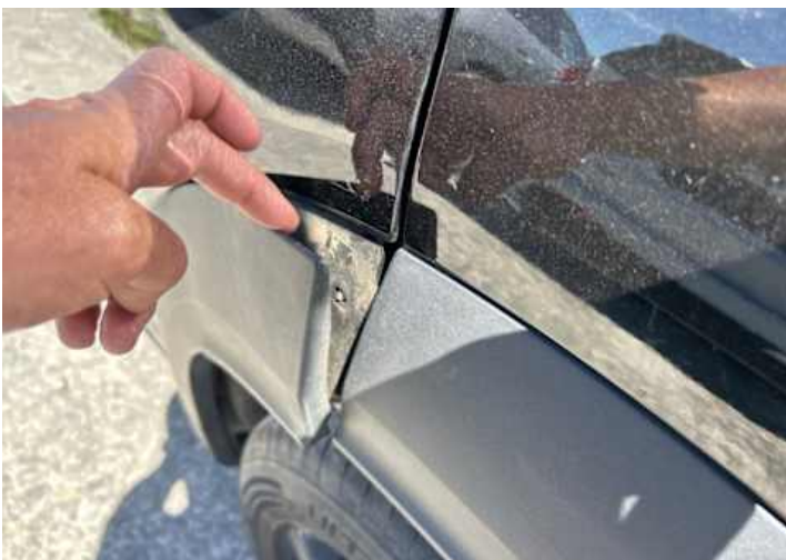
Türe hinten links (Spaltmaße ungenau)
