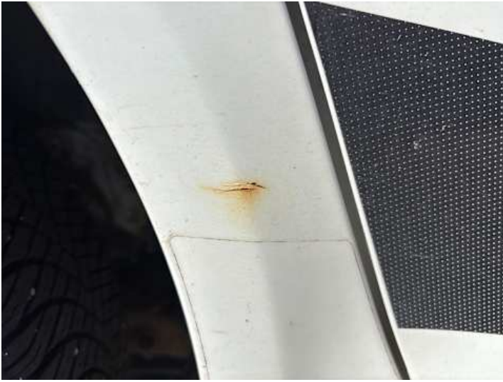
Seitenteil hinten rechts (Rost, Kratzer, Lackschaden)
