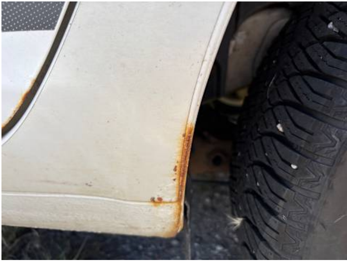
Seitenteil hinten links (Rost, Kratzer)
