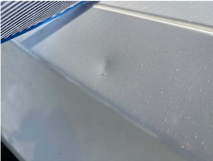
Kotflügel vorne links (Rost, Delle)
