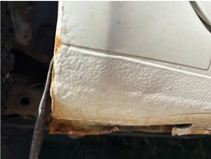
Schweller rechts (Rost)
