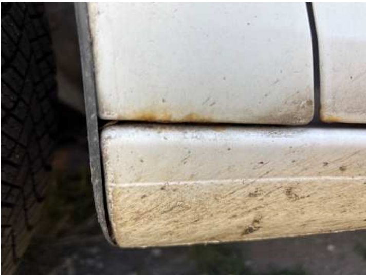
Kotflügel vorne links (Rost, Delle)
