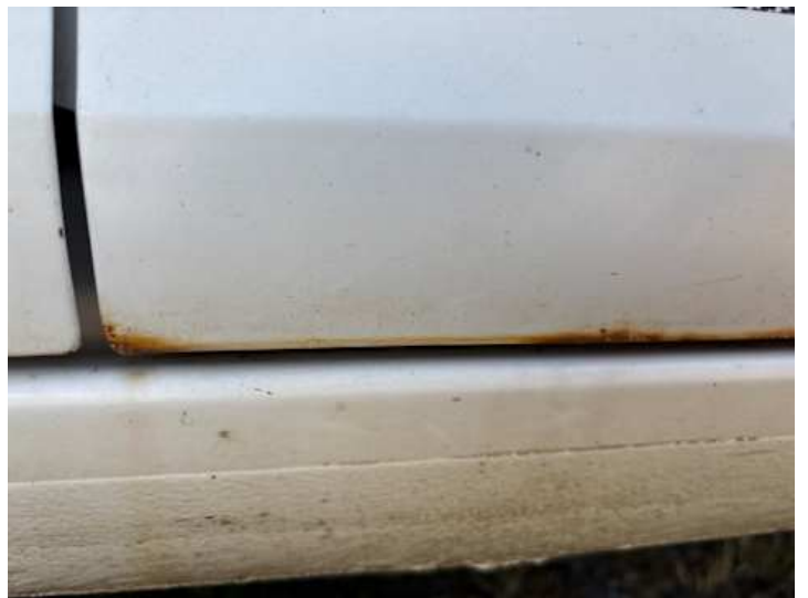
Türe hinten links (Rost)
