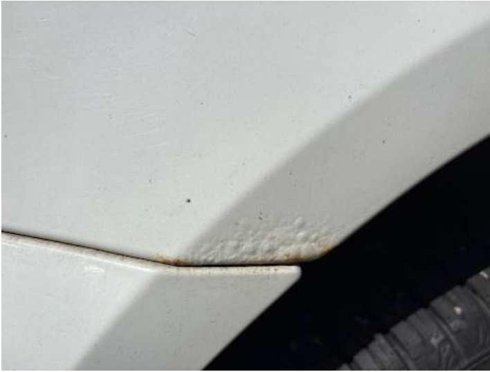
Seitenteil hinten rechts (Rost, Kratzer, Lackschaden)
