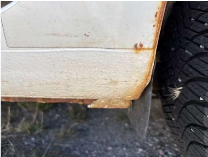
Schweller links (Rost)
