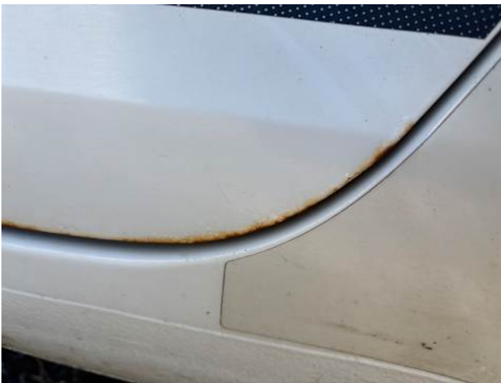
Türe hinten links (Rost)
