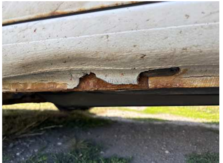
Schweller links (Rost)
