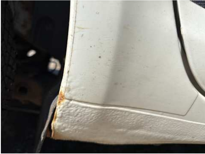
Seitenteil hinten rechts (Rost, Kratzer, Lackschaden)
