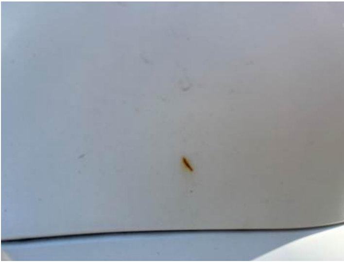
Seitenteil hinten links (Rost, Kratzer)
