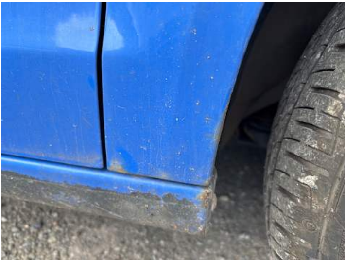
Kotflügel vorne rechts (Rost)
