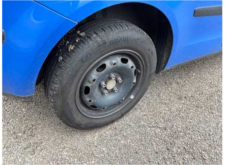
Rad (Anderer Schaden): Radkappe fehlt
