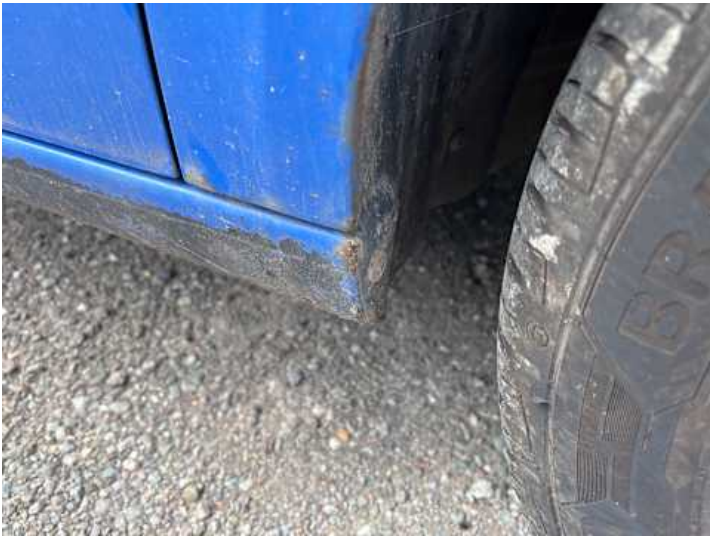
Schweller rechts (Rost)
