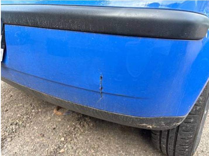
Stoßstange hinten (Riss/Bruch)
