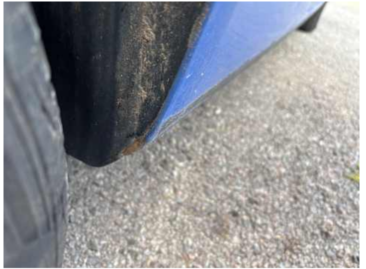
Schweller rechts (Rost)
