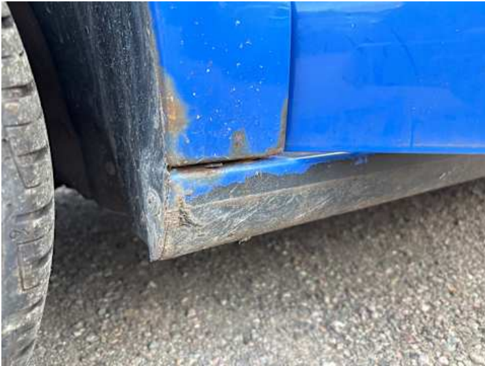
Schweller links (Rost)
