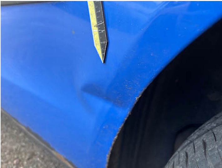
Seitenteil hinten links (Verformung)
