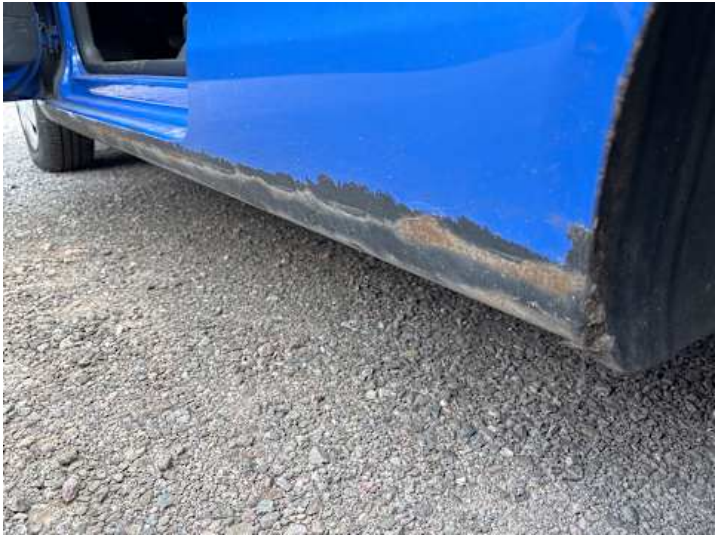
Schweller links (Rost)
