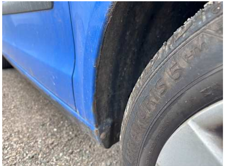
Kotflügel vorne rechts (Rost)
