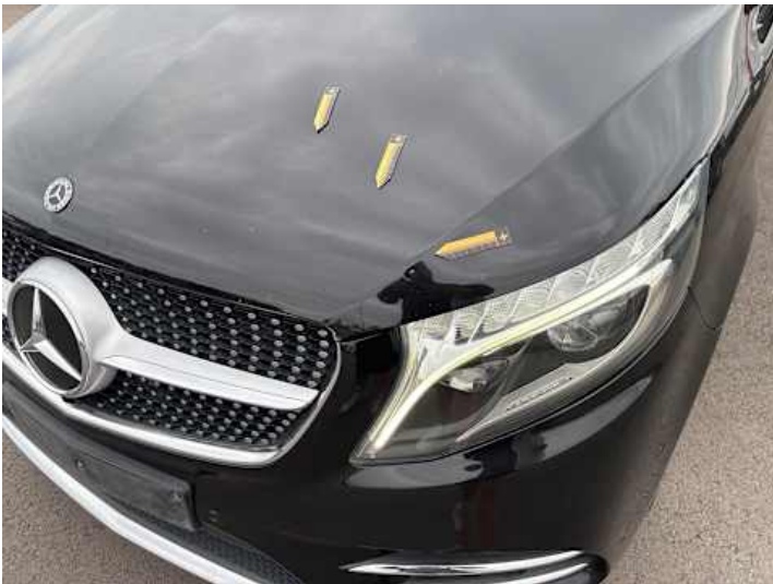
Motorhaube (Steinschlag, Delle, Rost)
