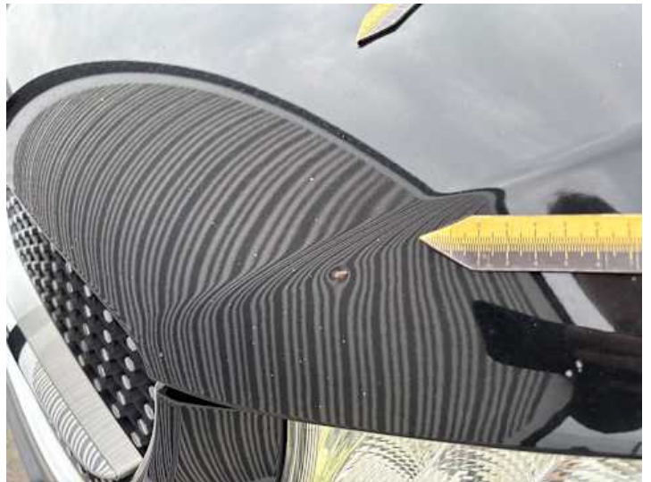
Motorhaube (Steinschlag, Delle, Rost)
