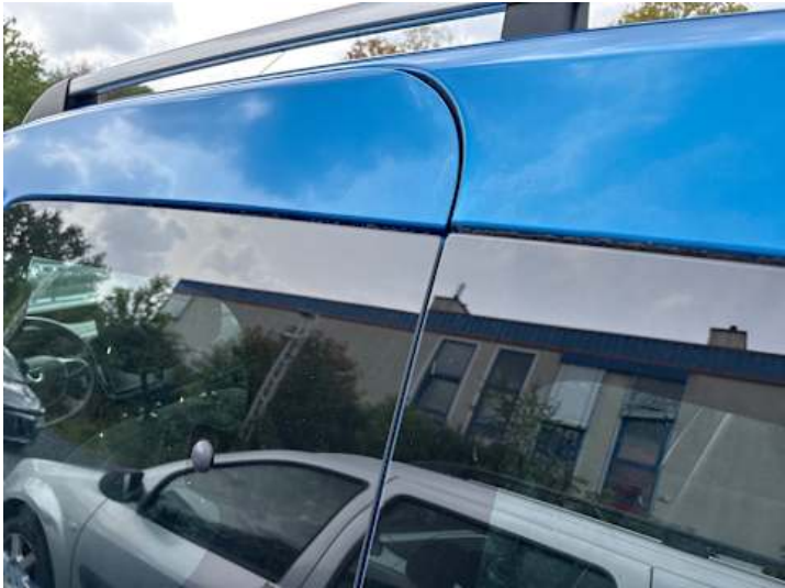
Türe hinten links (Spaltmaße ungenau)
