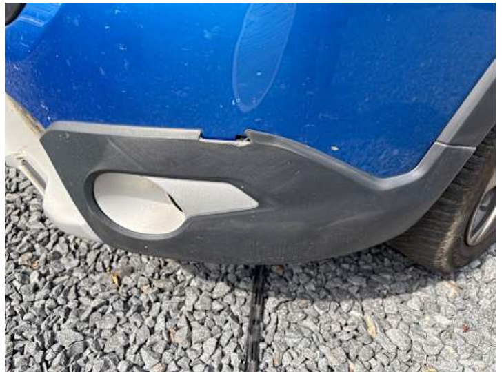
Stoßstange vorne (Kratzer, Riss/Bruch)
