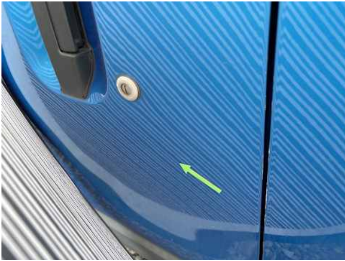
Türe hinten rechts (Delle, Kratzer)
