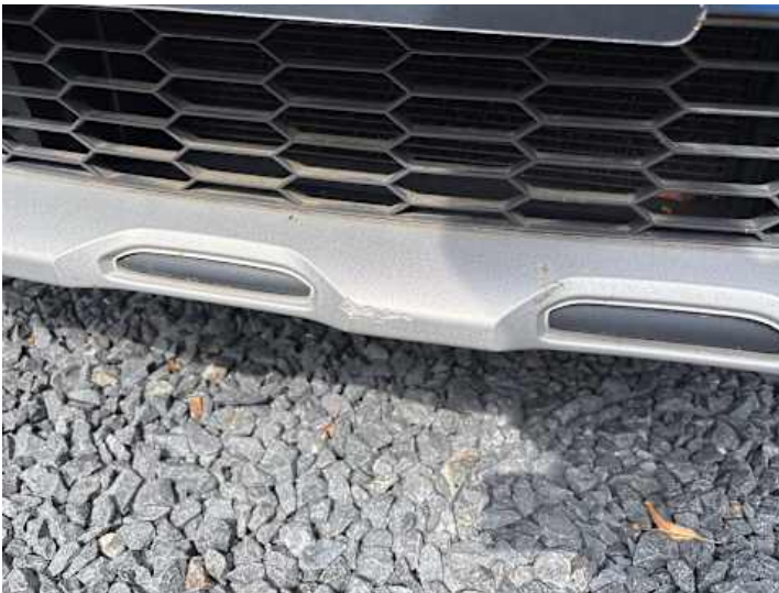
Stoßstange vorne (Kratzer, Riss/Bruch)
