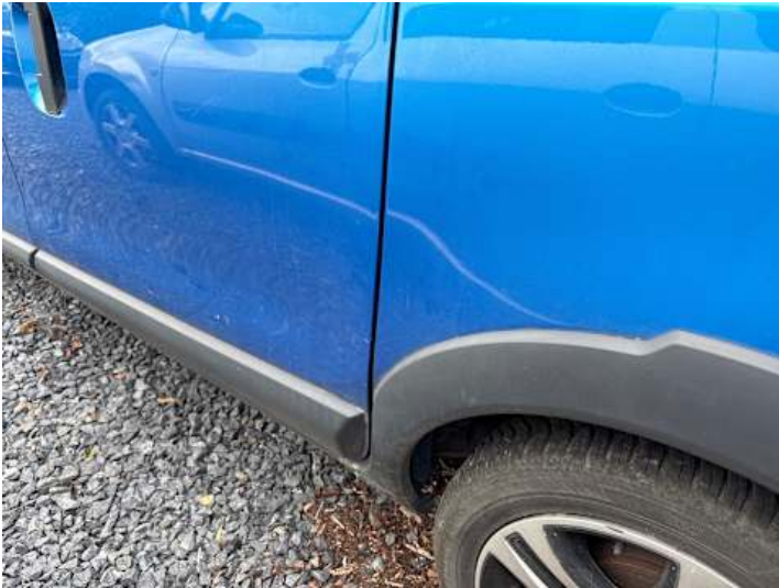
Türe hinten links (Spaltmaße ungenau)
