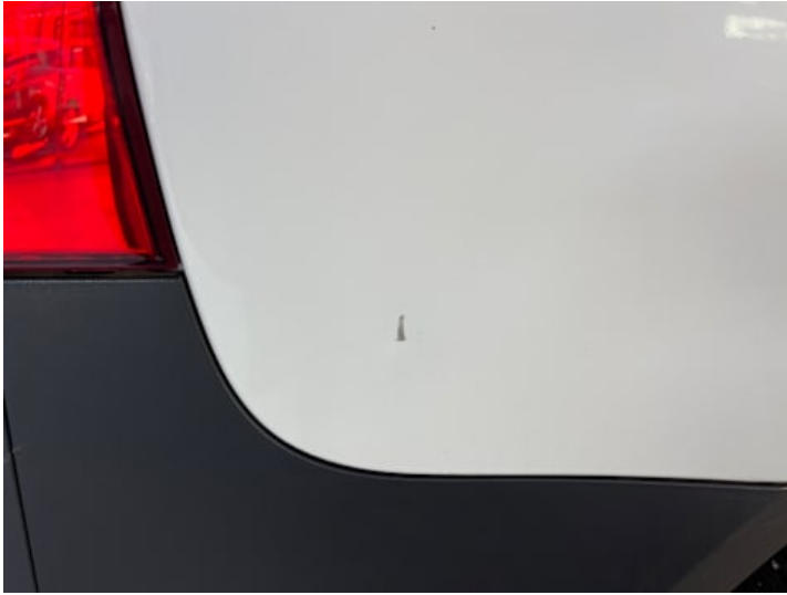
Seitenteil hinten rechts (Lackschaden, Rost)
