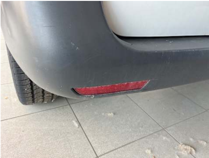
Stoßstange hinten (Kratzer, Verformung)
