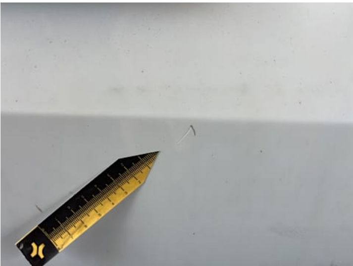
Heckklappe (Kratzer, Lackschaden)
