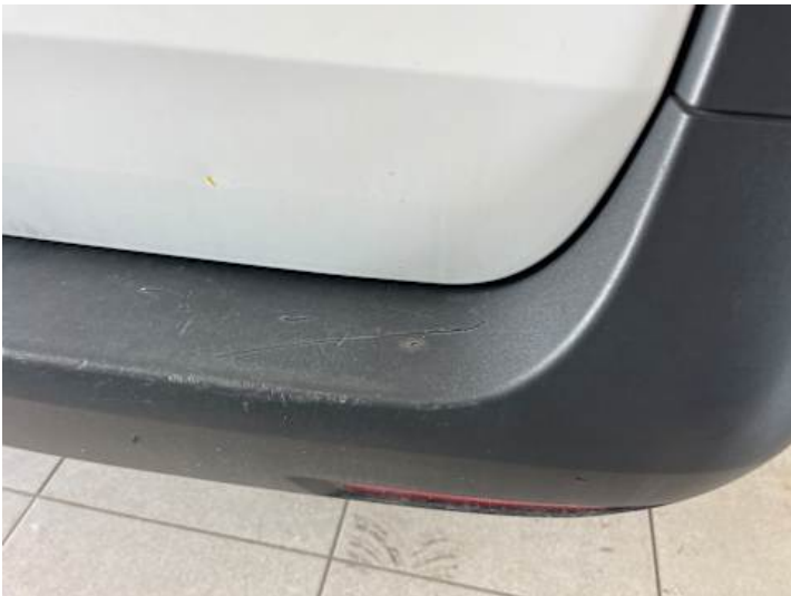
Stoßstange hinten (Kratzer, Verformung)
