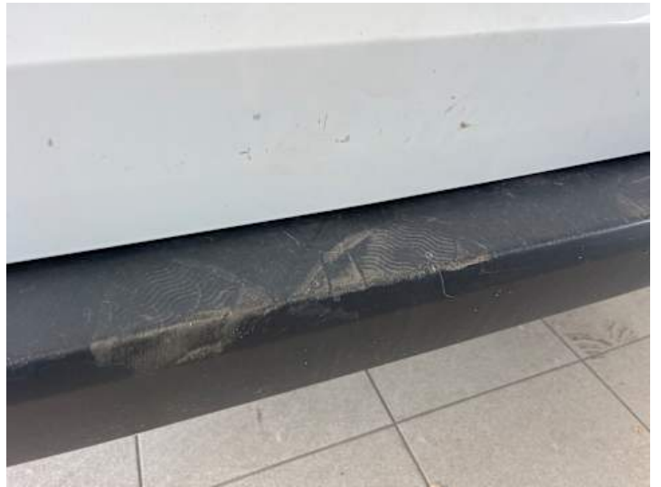
Stoßstange hinten (Kratzer, Verformung)
