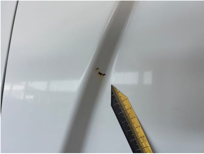
Seitenteil hinten rechts (Lackschaden, Rost)
