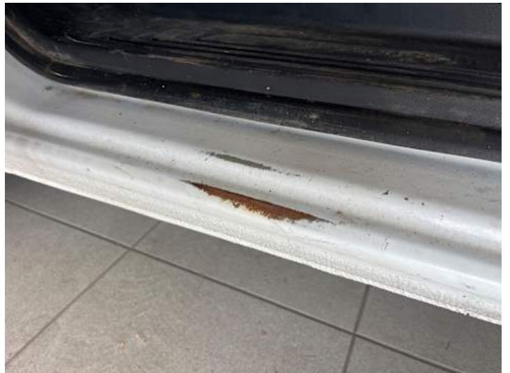
Schweller links (Rost, Lackschaden)
