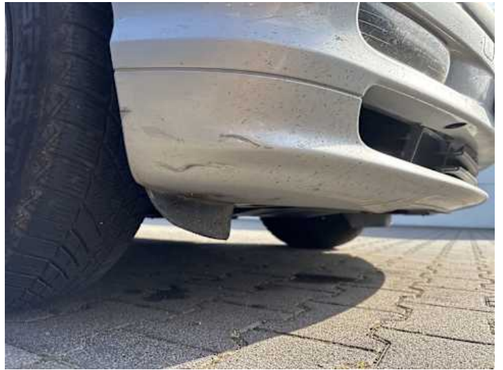
Stoßstange vorne (Lackschaden, Riss/Bruch)
