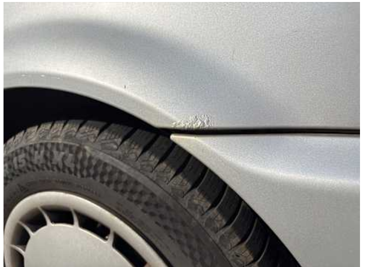
Seitenteil hinten links (Lackschaden, Rost)
