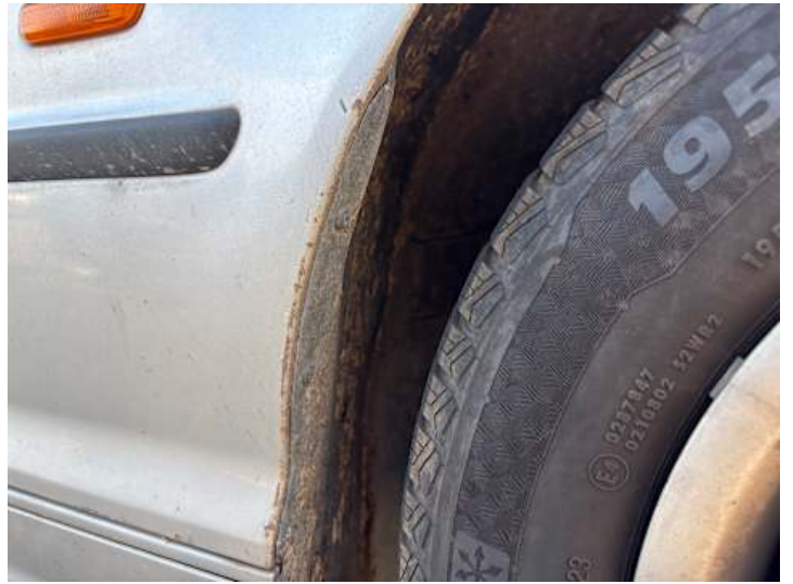
Kotflügel vorne rechts (Rost)
