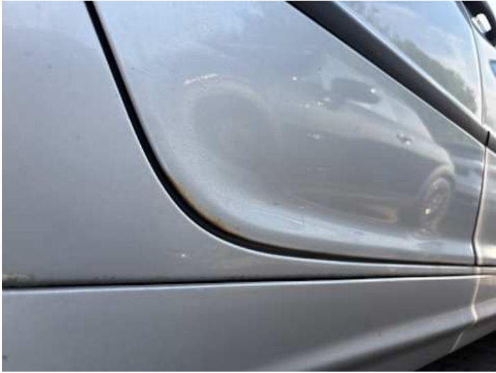
Türe hinten rechts (Rost)
