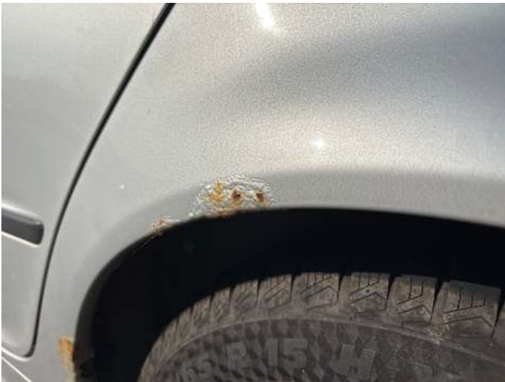
Seitenteil hinten links (Lackschaden, Rost)
