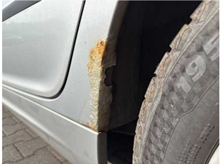
Seitenteil hinten links (Lackschaden, Rost)
