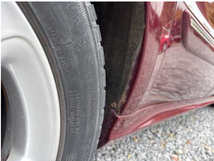
Seitenteil hinten rechts (Rost)
