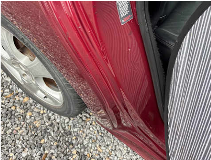
Schweller rechts (Kratzer, Delle)
