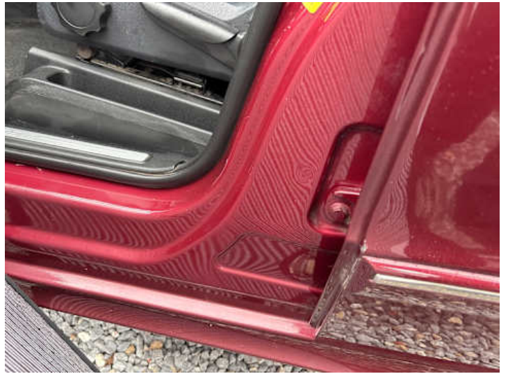
Schweller links (Delle)
