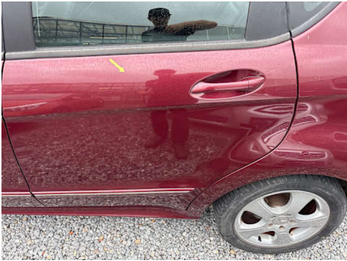
Türe hinten links (Kratzer, Lackschaden)
