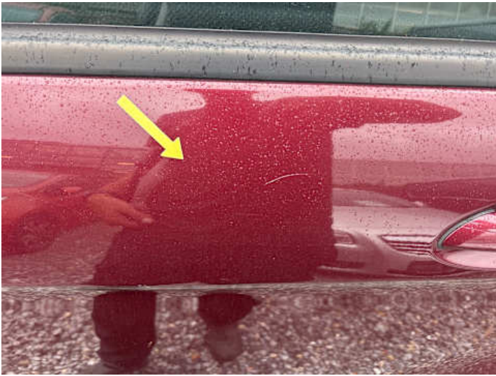
Türe hinten links (Kratzer, Lackschaden)
