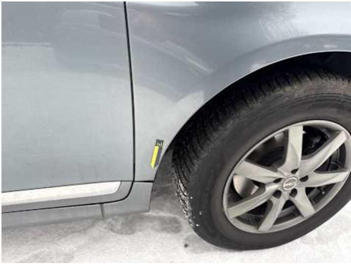
Kotflügel vorne rechts (Spaltmaße ungenau)
