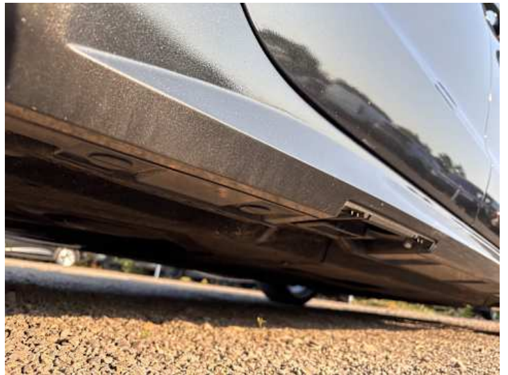
Schweller rechts (Anderer Schaden): Schutzkappe Wagenheber Aufnahme fehlt
