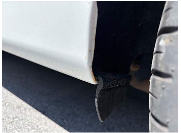
Schweller links (Rost)
