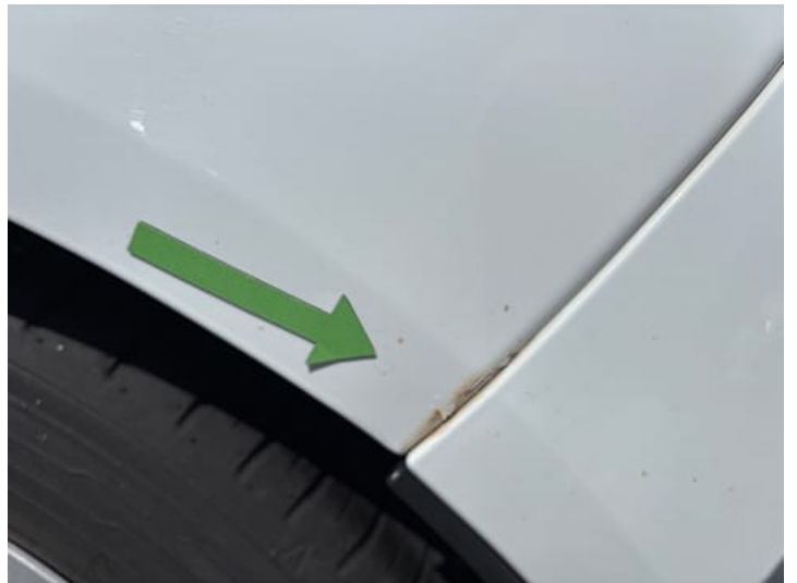
Seitenteil hinten links (Rost)
