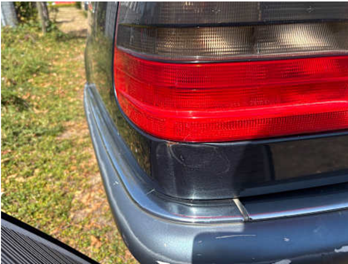
Seitenteil hinten links (Verformung)
