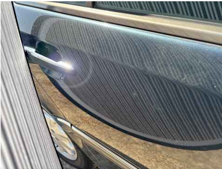
Türe hinten rechts (Delle)
