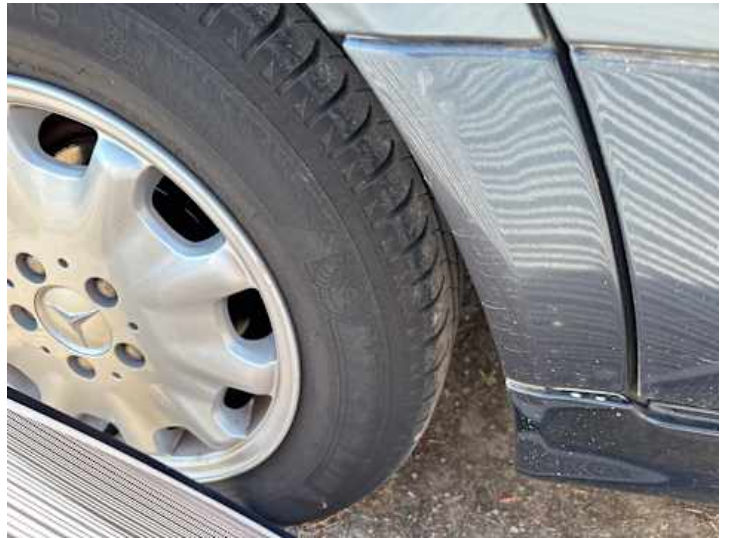
Seitenteil hinten rechts (Rost, Spaltmaße ungenau)
