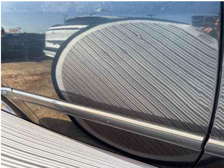
Türe hinten rechts (Delle)
