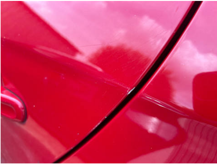
Türe hinten links (Lackschaden)
