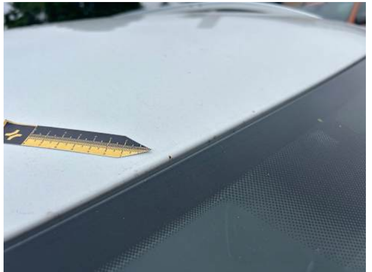
Dach (Steinschlag, Rost)
