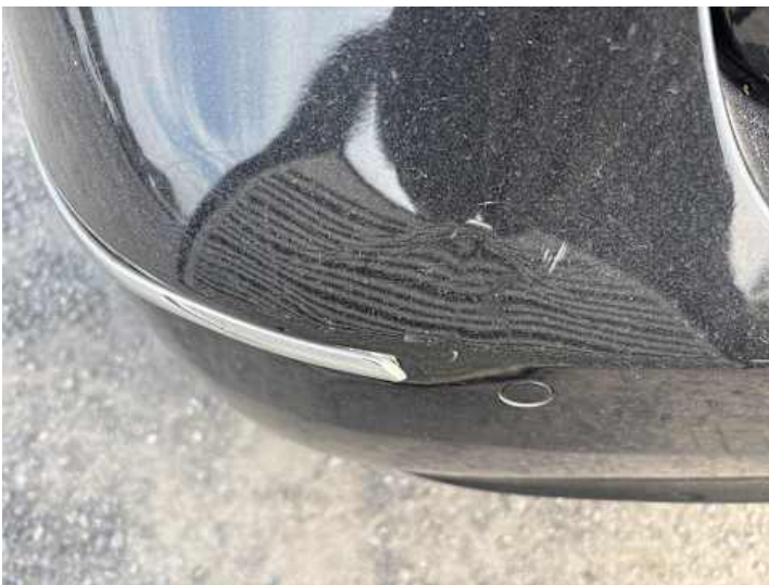
Stoßstange hinten (Verformung, Riss/Bruch)
