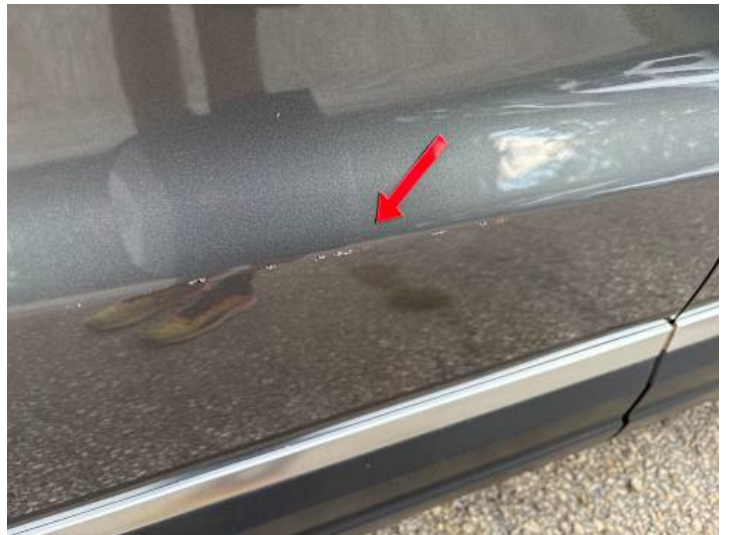
Fahrtür (Kratzer, Delle)
