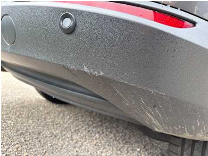
Stoßstange hinten (Kratzer)
