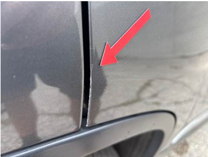
Türe hinten rechts (Lackschaden)
