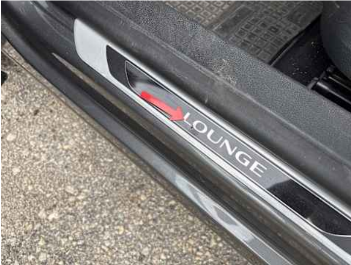
Schweller links (Delle)
