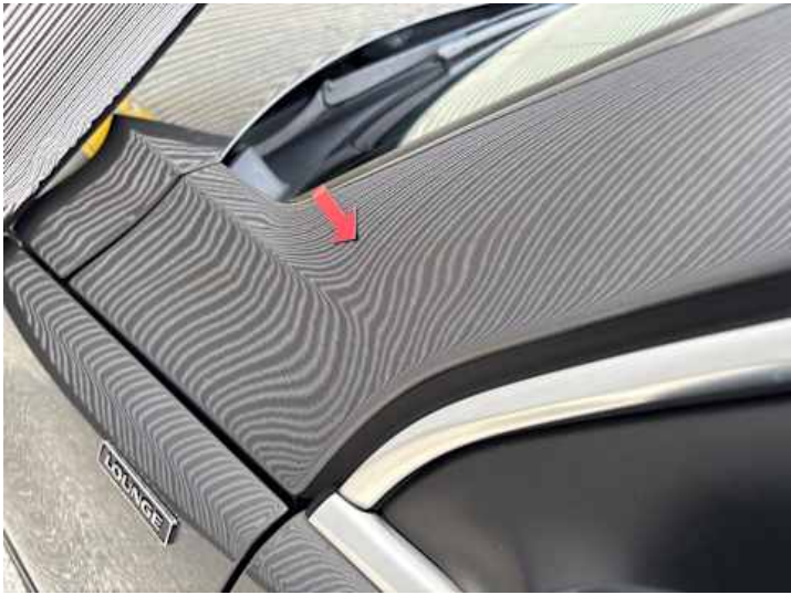
Seitenteil hinten links (Delle)
