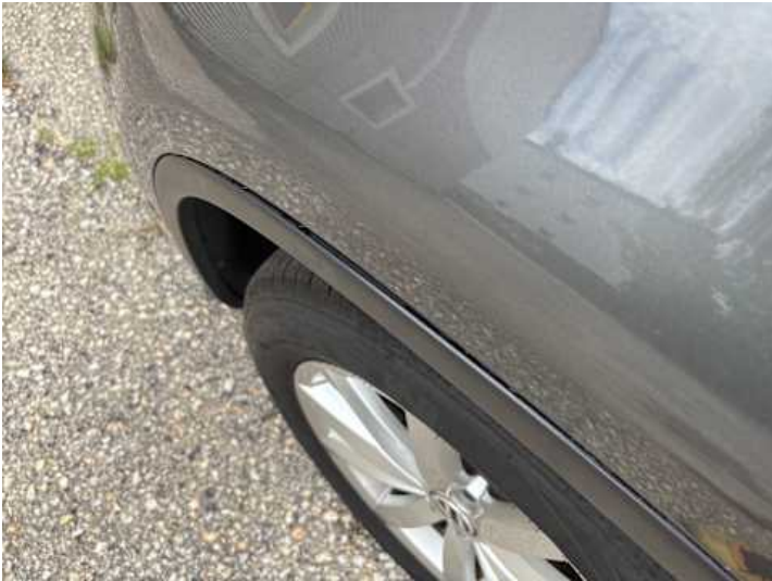
Kotflügel vorne links (Spaltmaße ungenau)
