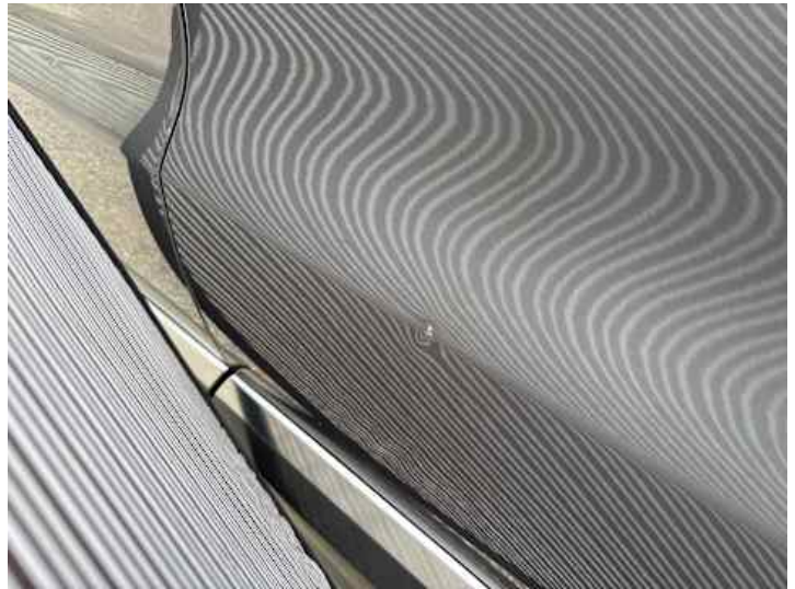
Türe hinten links (Delle, Lackschaden)
