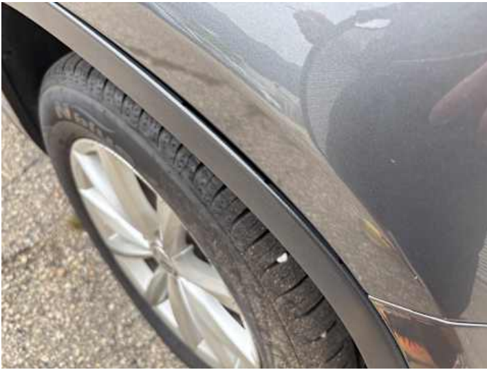
Kotflügel vorne rechts (Spaltmaße ungenau)
