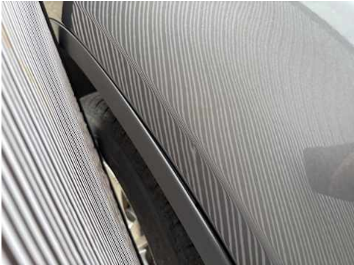
Kotflügel vorne rechts (Delle)
