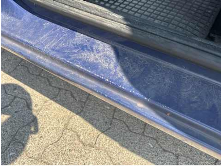
Schweller links (Kratzer, Delle)
