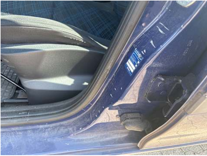
Schweller links (Kratzer, Delle)
