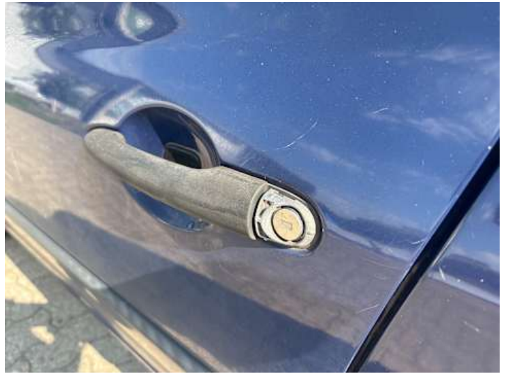
Fahrtür (Riss/Bruch, Kratzer)
