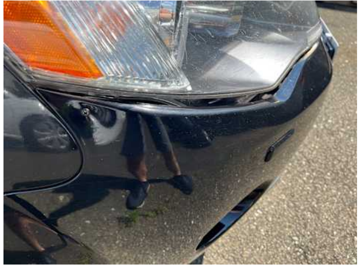
Stoßstange vorne (Spaltmaße ungenau, Unsachgemäß instand gesetzt, Kratzer, Lackschaden)
