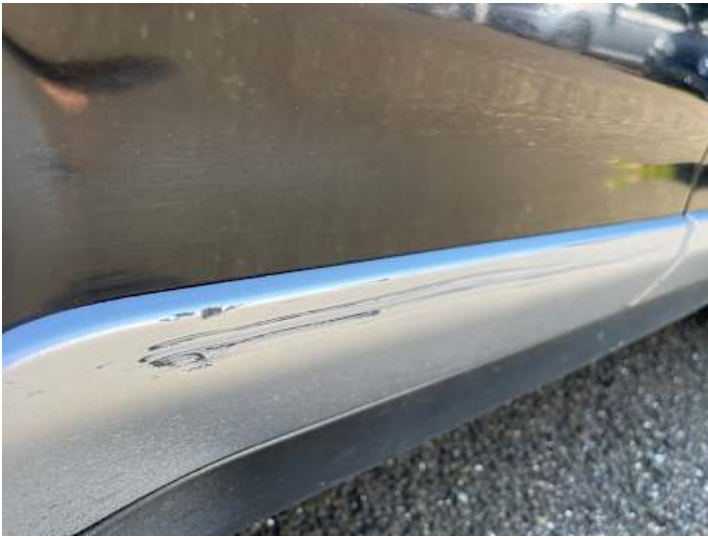
Türe hinten rechts (Lackschaden, Kratzer, Delle)
