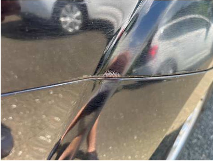
Seitenteil hinten rechts (Rost)
