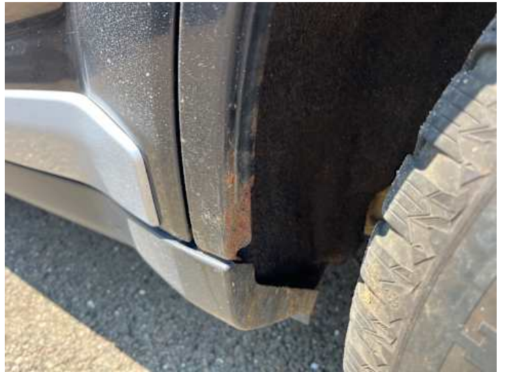
Seitenteil hinten links (Rost)
