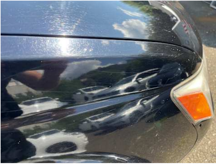
Kotflügel vorne rechts (Kratzer, Lackschaden)
