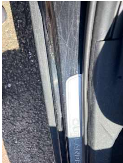
Schweller rechts (Delle, Kratzer)
