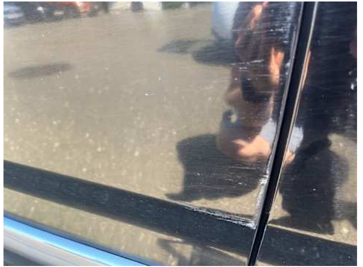
Türe hinten rechts (Lackschaden, Kratzer, Delle)
