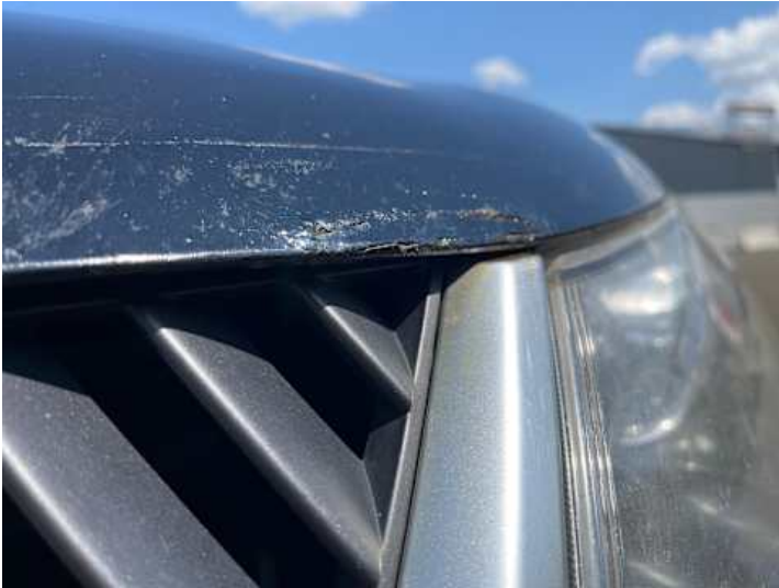
Motorhaube (Rost, Unsachgemäß instand gesetzt)
