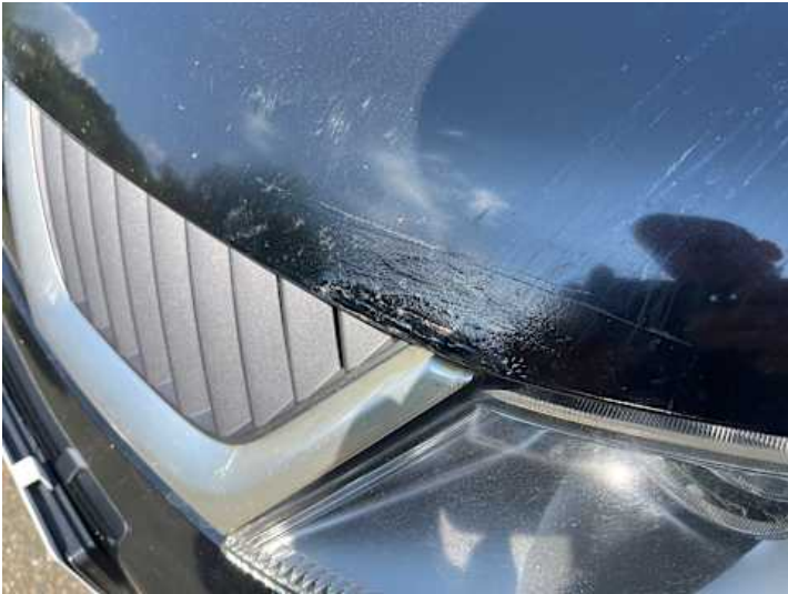
Motorhaube (Rost, Unsachgemäß instand gesetzt)
