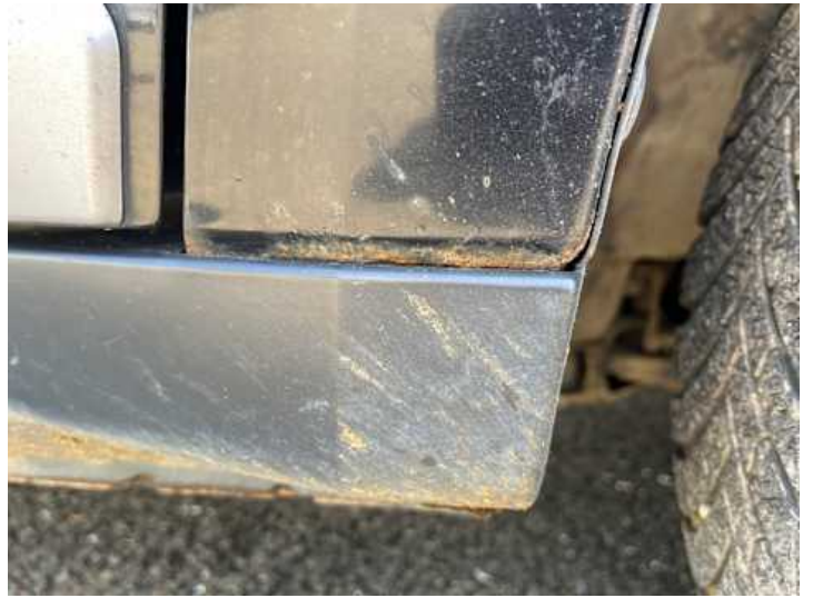
Kotflügel vorne rechts (Rost)
