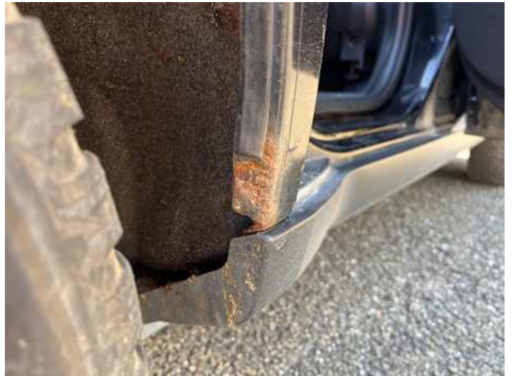
Schweller rechts (Rost)
