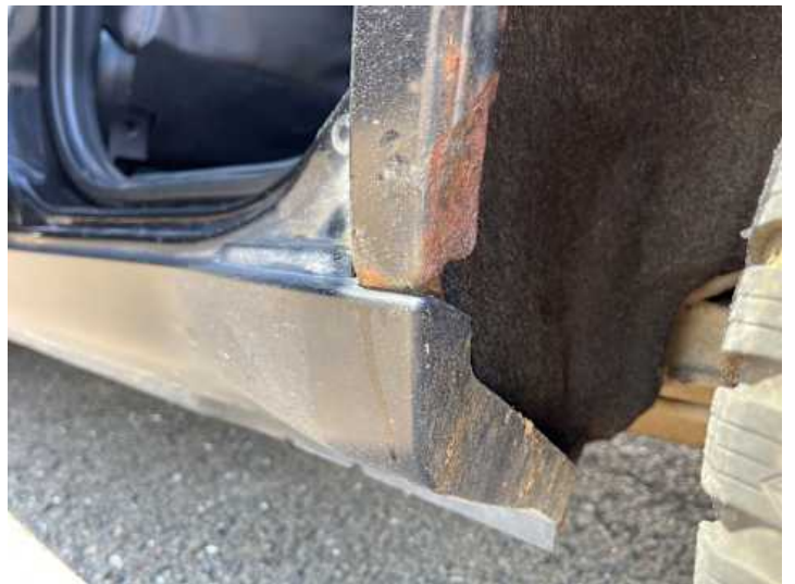
Schweller links (Rost)
