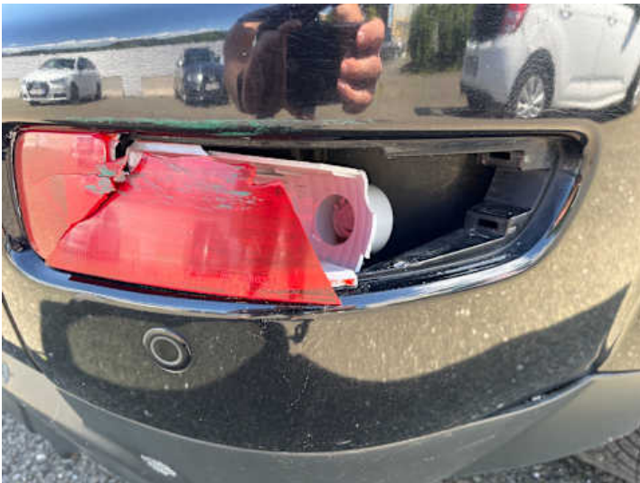
Rücklicht (rechts) (Riss/Bruch)
