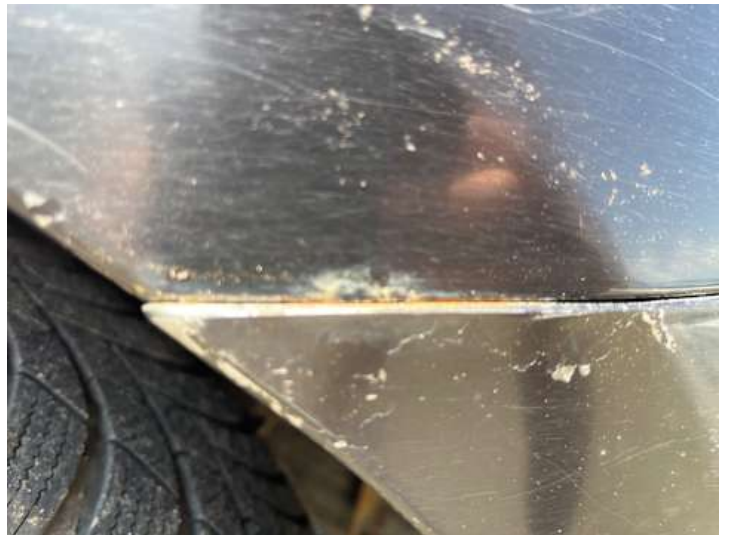
Seitenteil hinten links (Rost)
