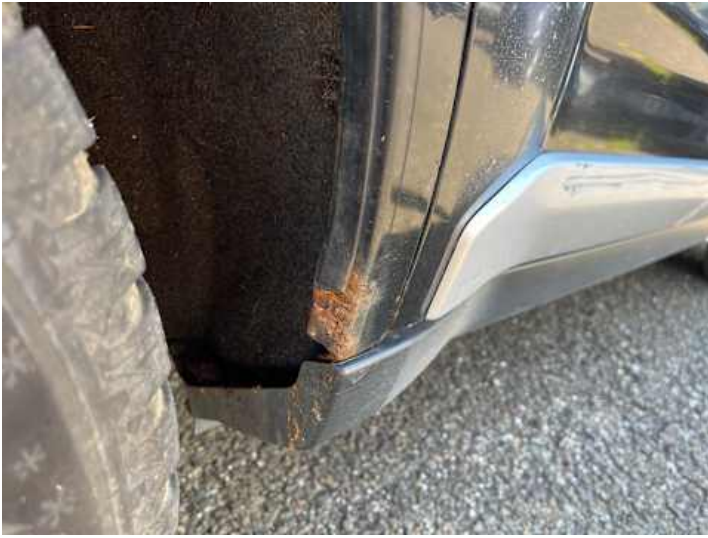
Seitenteil hinten rechts (Rost)
