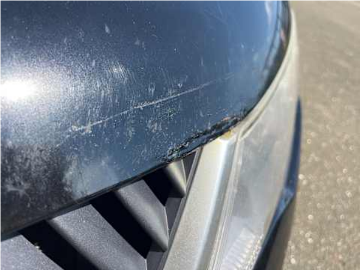
Motorhaube (Rost, Unsachgemäß instand gesetzt)
