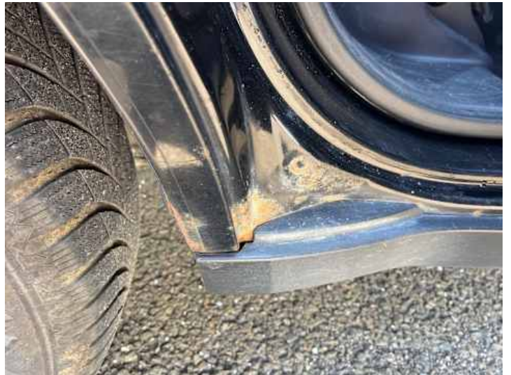
Schweller rechts (Rost)
