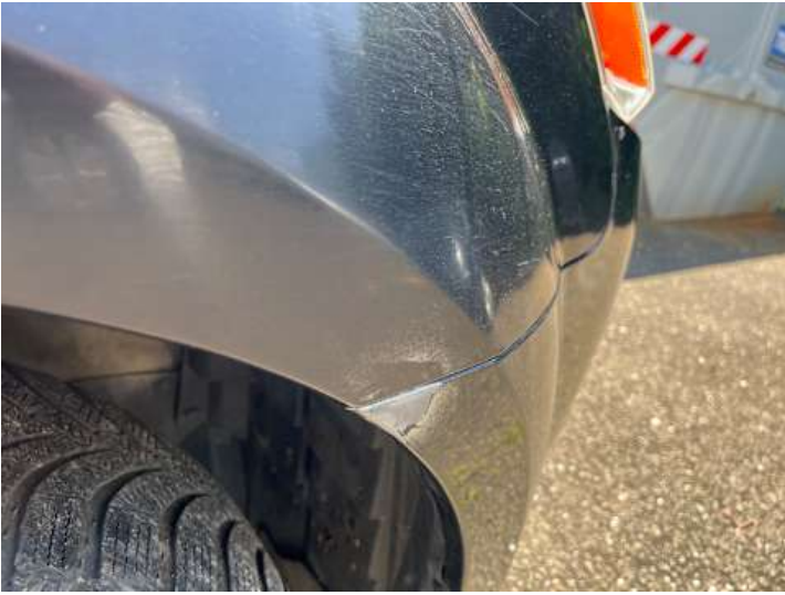
Kotflügel vorne rechts (Kratzer, Lackschaden)
