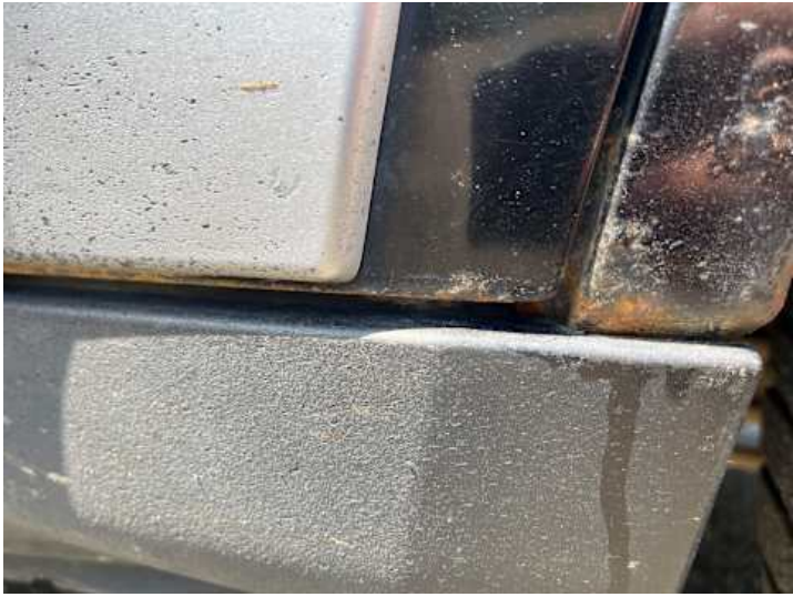
Türe hinten links (Rost)
