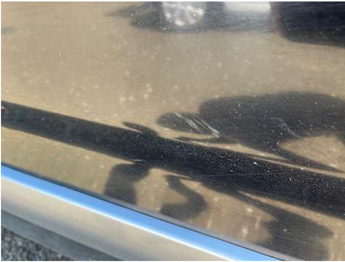
Beifahrertür (Kratzer, Delle)
