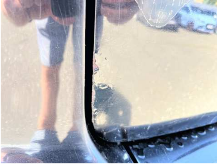
Heckklappe (Lackschaden, Rost, Kratzer)
