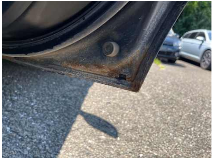
Türe hinten rechts (Rost)
