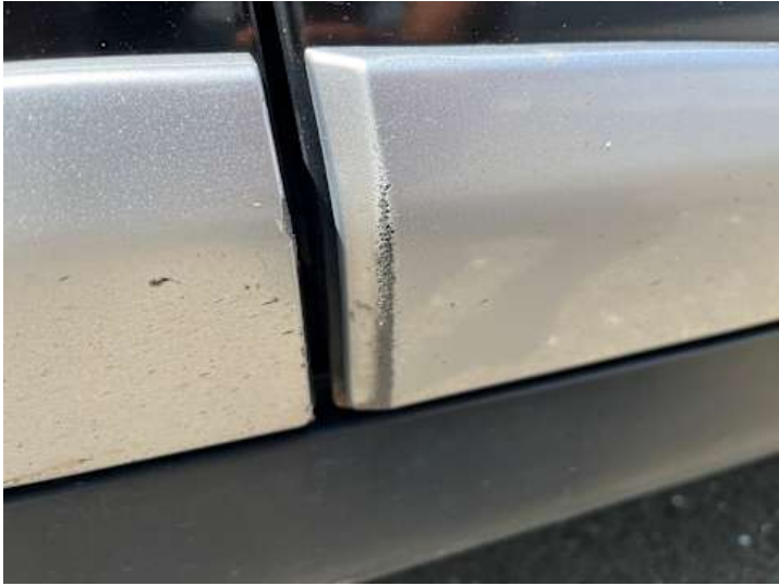
Türe hinten links (Kratzer, Lackschaden)
