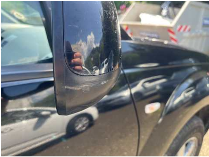
Beifahrertür (Kratzer, Delle)
