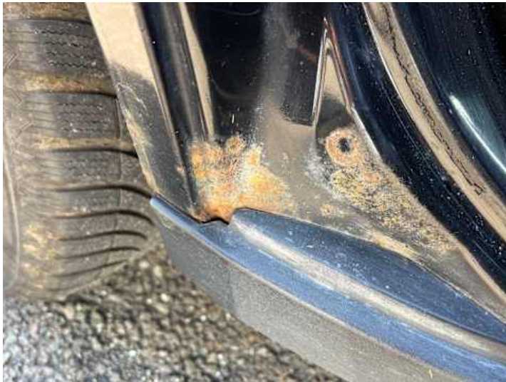
Schweller rechts (Rost)
