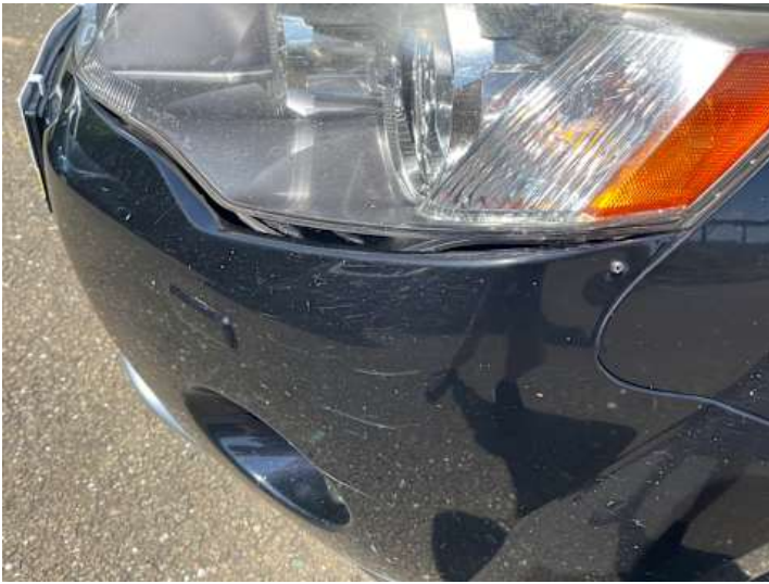
Stoßstange vorne (Spaltmaße ungenau, Unsachgemäß instand gesetzt, Kratzer, Lackschaden)
