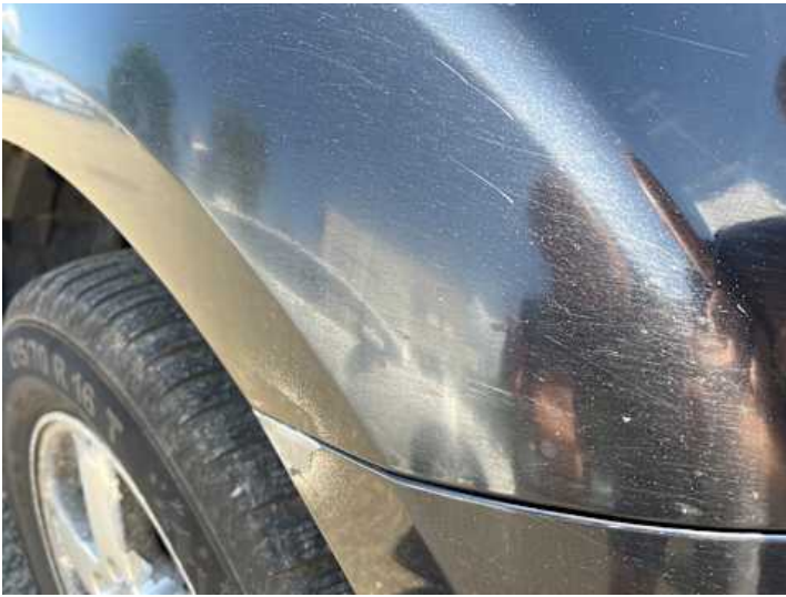
Kotflügel vorne rechts (Kratzer, Lackschaden)
