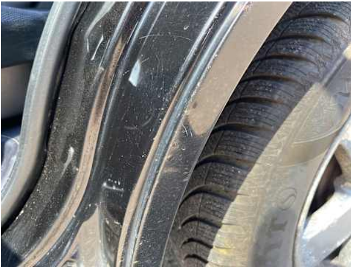
Seitenteil hinten links (Rost)
