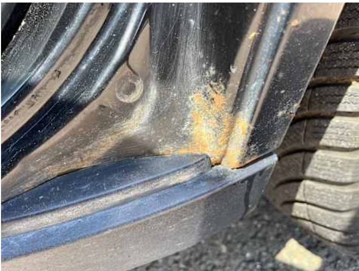
Schweller links (Rost)
