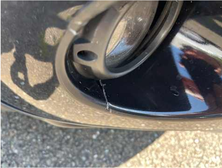
Stoßstange vorne (Riss/Bruch)
