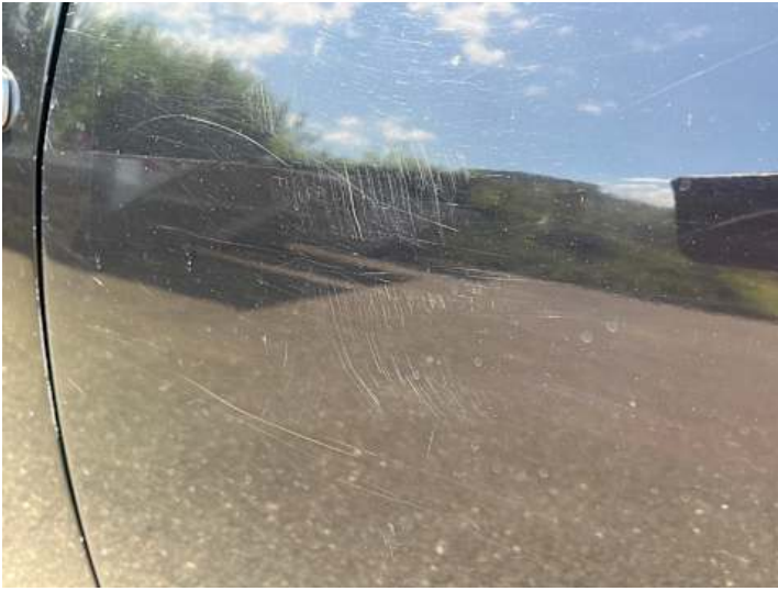
Türe hinten links (Kratzer, Lackschaden)
