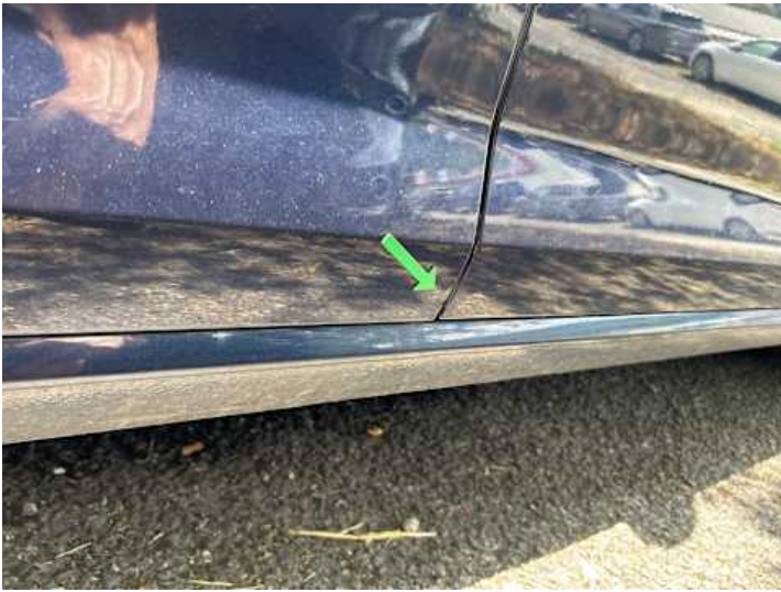
Türe hinten rechts (Rost)
