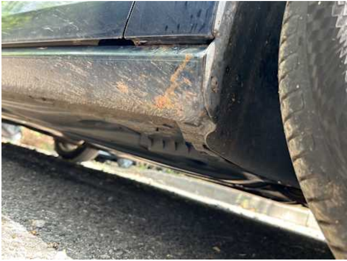
Schweller rechts (Rost)
