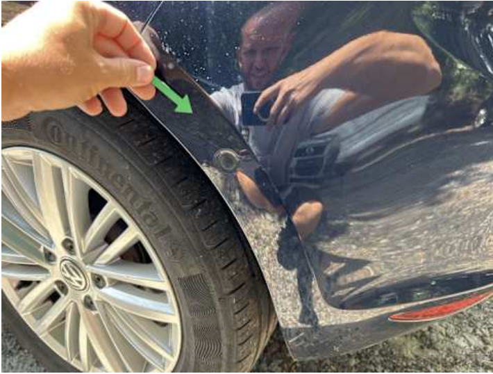
Stoßstange hinten (Kratzer, Verformung)
