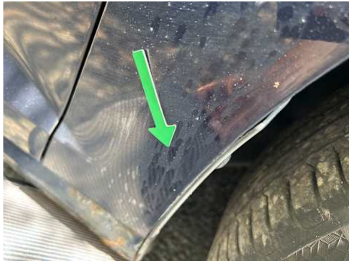
Kotflügel vorne rechts (Delle, Rost)
