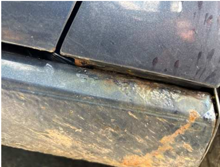
Kotflügel vorne rechts (Delle, Rost)
