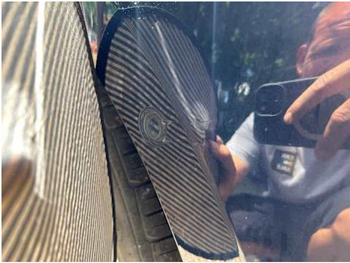
Stoßstange hinten (Kratzer, Verformung)
