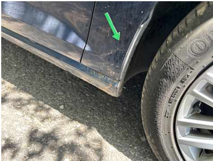
Kotflügel vorne rechts (Delle, Rost)
