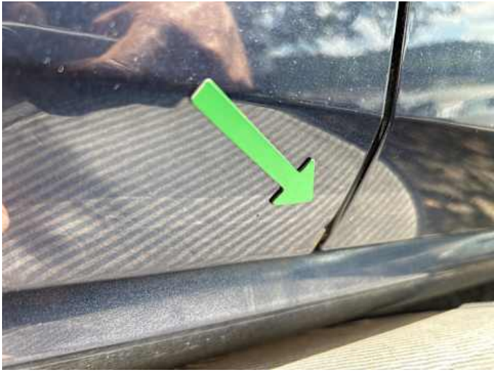
Türe hinten rechts (Rost)
