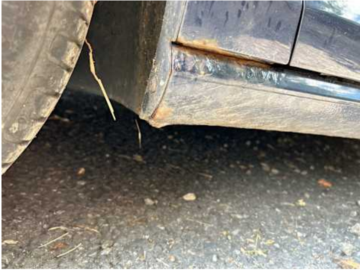
Schweller links (Rost)
