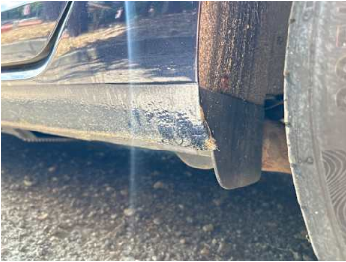
Schweller links (Rost)
