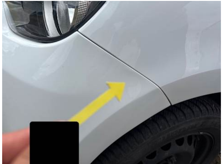
Stoßstange vorne (Spaltmaße ungenau)
