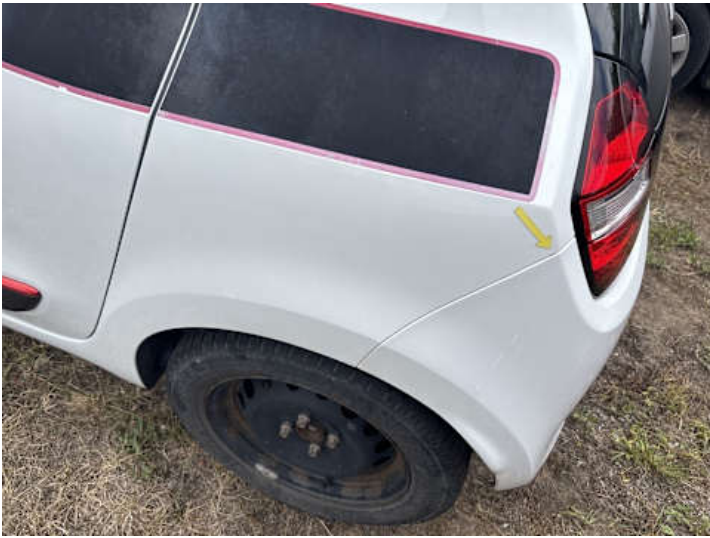
Stoßstange hinten (Spaltmaße ungenau, Kratzer)
