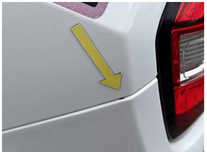
Stoßstange hinten (Spaltmaße ungenau, Kratzer)
