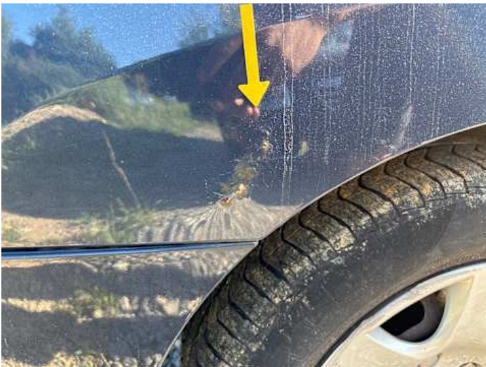
Seitenteil hinten rechts (Rost, Unsachgemäß instand gesetzt, Kratzer, Verformung)
