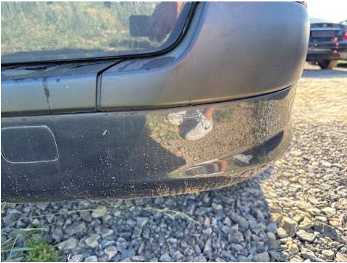
Stoßstange hinten (Spaltmaße ungenau, Kratzer, Lackschaden)
