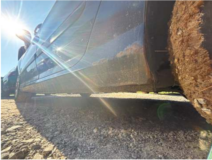
Schweller links (Rost)
