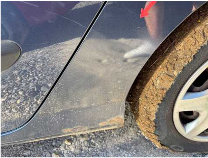
Seitenteil hinten links (Unsachgemäß instand gesetzt)
