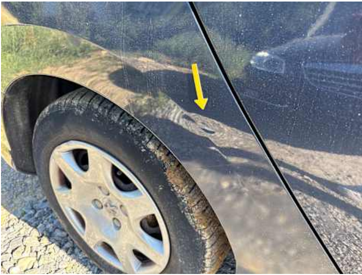
Seitenteil hinten rechts (Rost, Unsachgemäß instand gesetzt, Kratzer, Verformung)
