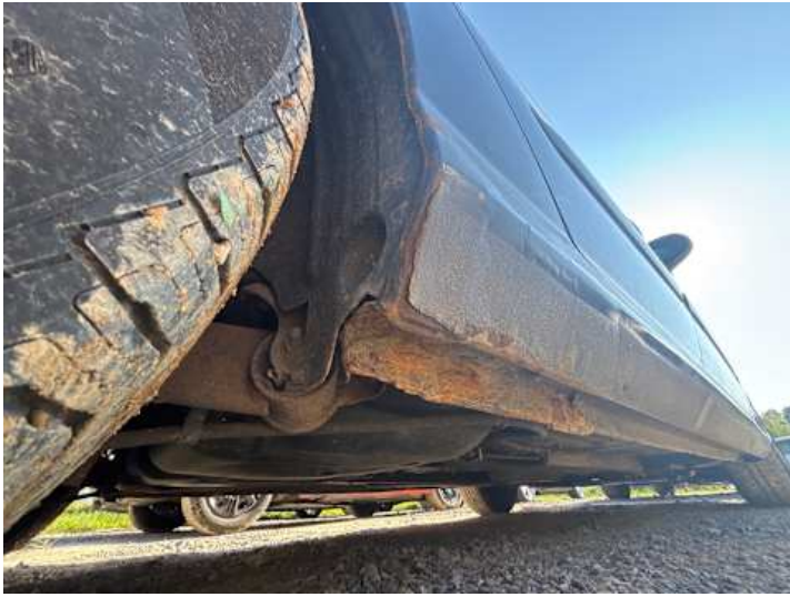
Schweller rechts (Rost)
