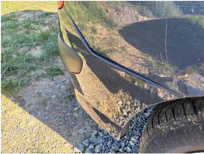
Stoßstange hinten (Spaltmaße ungenau, Kratzer, Lackschaden)
