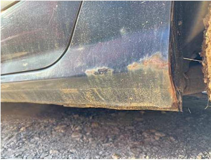
Schweller links (Rost)
