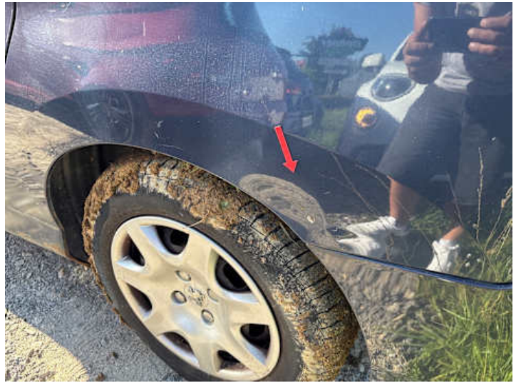
Seitenteil hinten links (Rost, Verformung)
