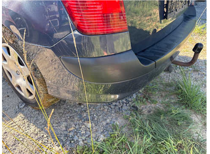
Stoßstange hinten (Spaltmaße ungenau, Kratzer, Lackschaden)
