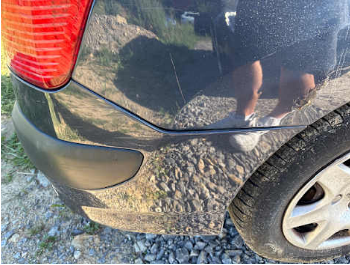
Stoßstange hinten (Spaltmaße ungenau, Kratzer, Lackschaden)
