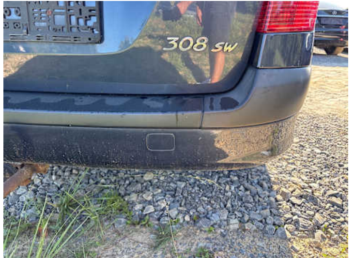
Stoßstange hinten (Spaltmaße ungenau, Kratzer, Lackschaden)
