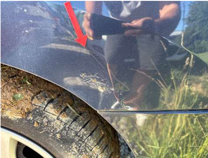
Seitenteil hinten links (Rost, Verformung)
