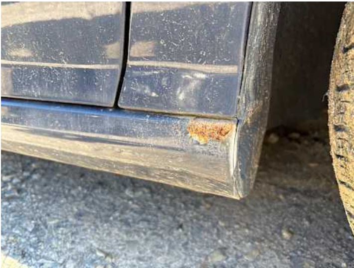
Schweller rechts (Rost)
