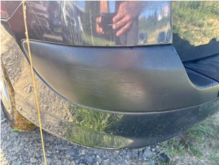
Stoßstange hinten (Spaltmaße ungenau, Kratzer, Lackschaden)
