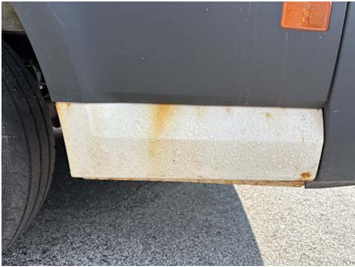
Seitenteil hinten links (Rost)
