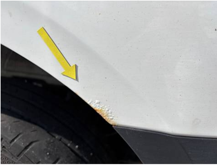
Seitenteil hinten rechts (Rost)
