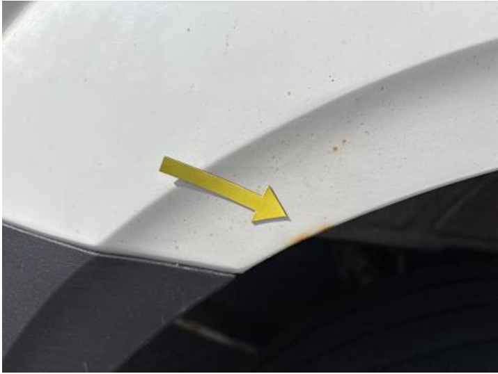
Seitenteil hinten rechts (Rost)
