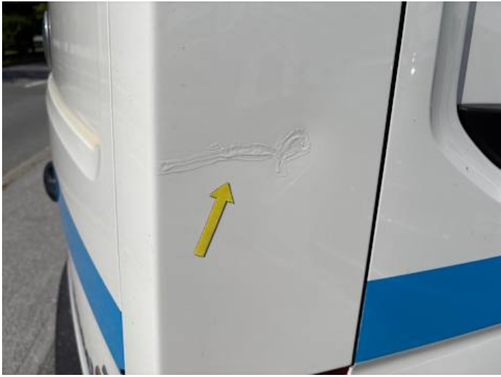
Seitenteil hinten rechts (Unschlaggemäß instand gesetzt)
