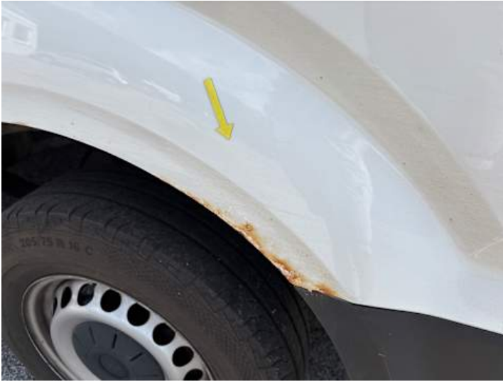
Seitenteil hinten links (Rost)
