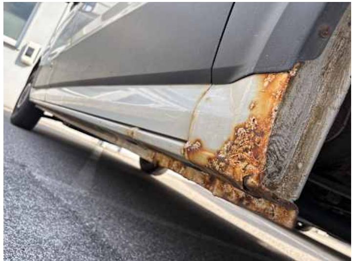
Schweller links (Rost)
