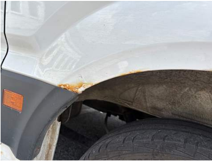
Seitenteil hinten links (Rost)
