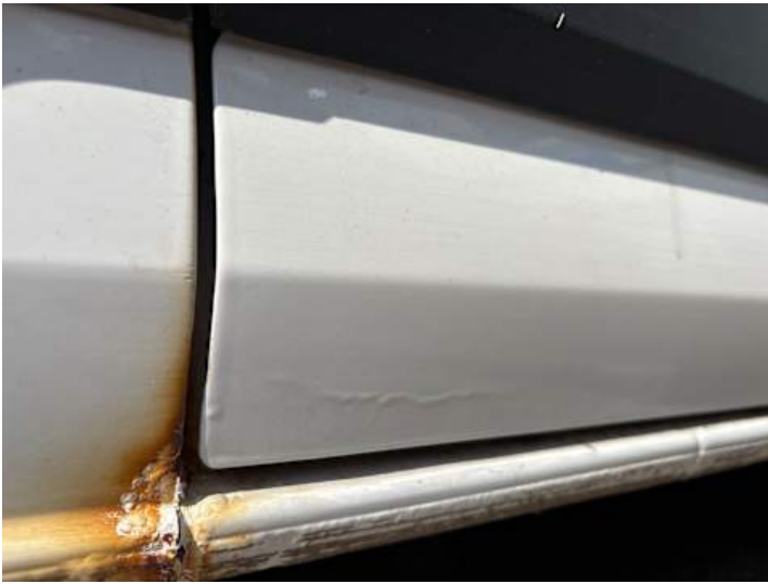
Türe hinten rechts (Unsachgemäß instand gesetzt)
