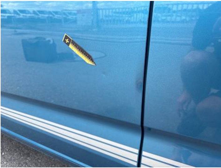
Fahrertür (Delle, Kratzer)
