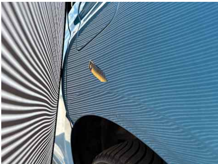
Seitenteil hinten links (Delle, Kratzer)
