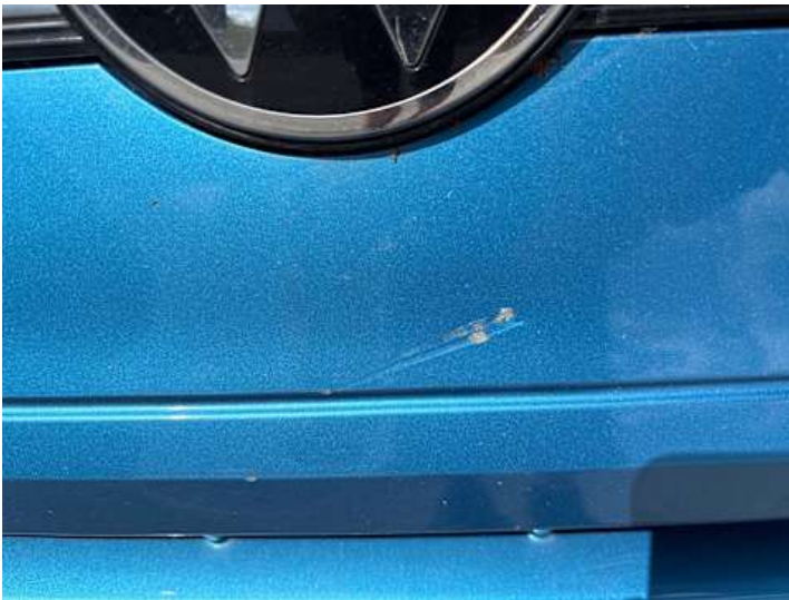
Stoßstange vorne (Kratzer)
