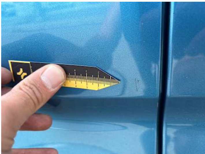
Fahrtür (Delle, Kratzer)
