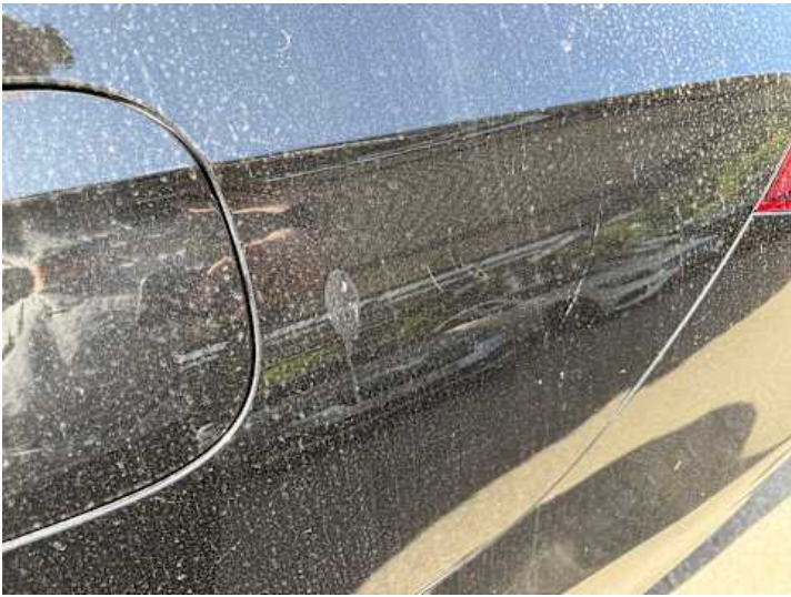
Seitenteil hinten links (Lackschaden)
