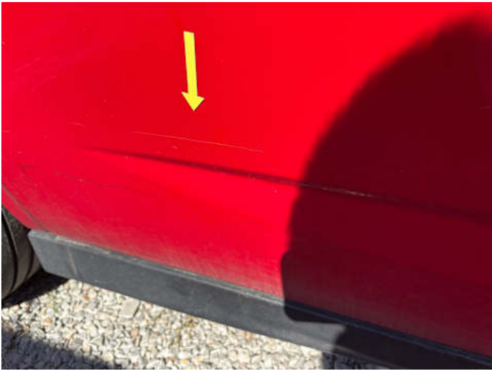
Türe hinten rechts (Lackschaden, Kratzer)
