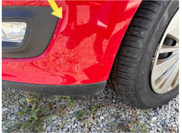
Stoßstange vorne (Lackschaden, Kratzer)
