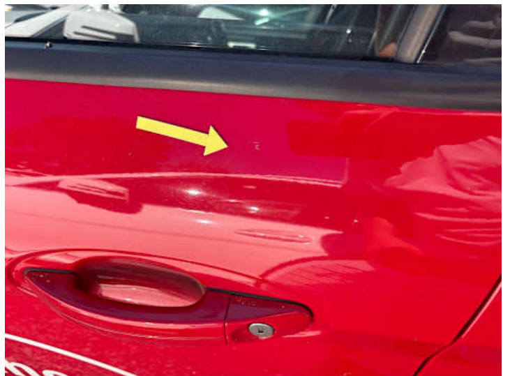
Fahrertür (Delle, Lackschaden)
