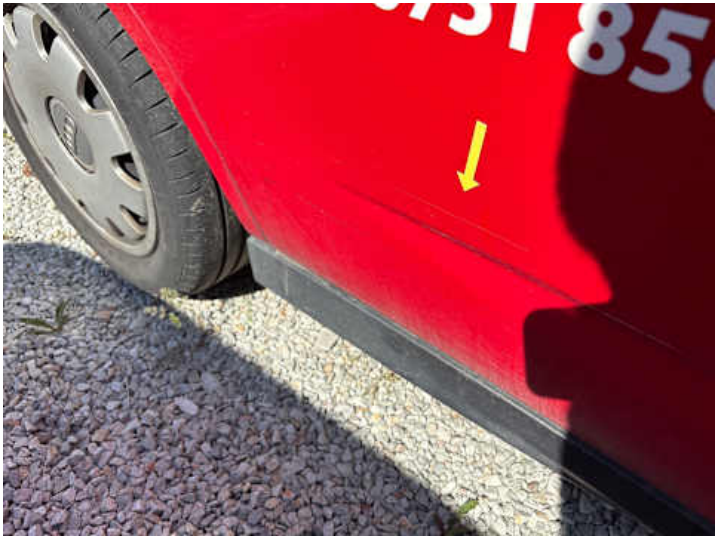
Türe hinten rechts (Lackschaden, Kratzer)
