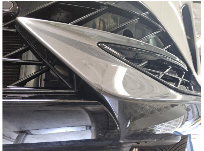
Blende Stoßfänger vorne links Kratzer
