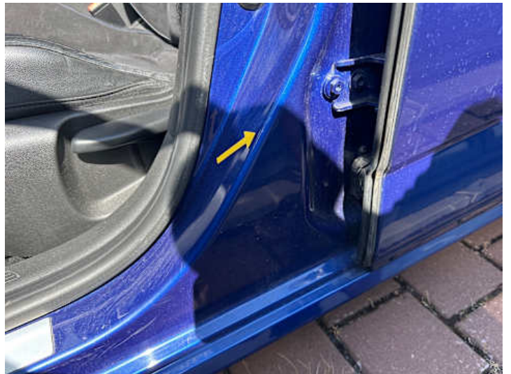
Fahrtür (Kratzer, Delle)
