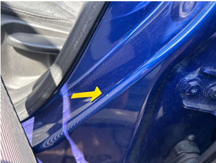
Fahrtür (Kratzer, Delle)
