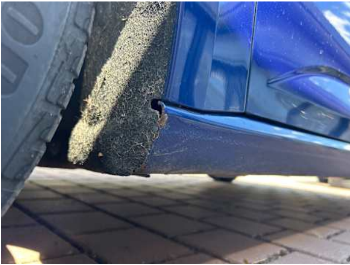
Schweller links (Rost)
