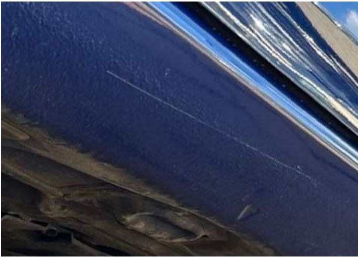
Schweller rechts (Kratzer)
